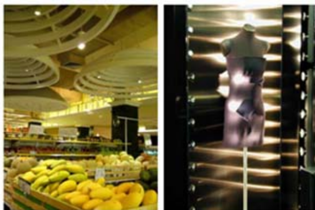
ภาพประกอบ 10 การให้แสงเพื่อส่องผลไม้ใน Villa Market โดยใช้แสงจากหลอดฮาโลเจนที่มีตัวสะท้อนแสงเฉพาะส่องผักและผลไม้เพื่อให้สีส้มของทั้งผักและผลไม้ดูสดใสมากขึ้น
