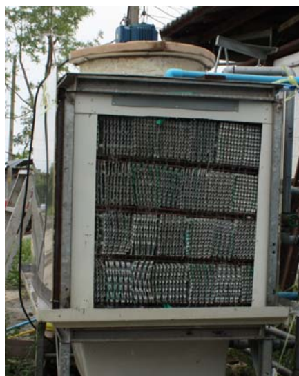
ภาพประกอบ 21 หอทำความเย็นรูปแบบการจัดวางแผงกระจายละอองน้ำรูปแบบใหม่
