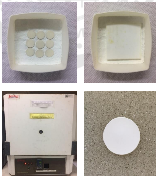
ภาพประกอบ 41 ขั้นตอนการเตรียมการเผาผนึกแผ่น PLZT
