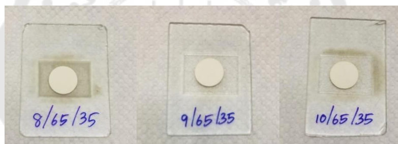
ภาพประกอบ 43 การเตรียมชิ้นงานก่อนเข้าเครื่อง X-Ray Diffractometer
