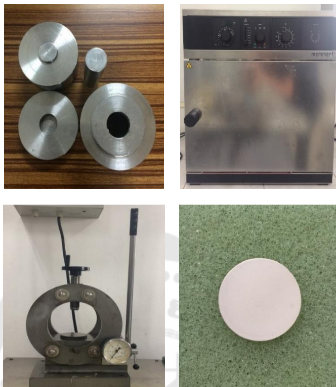
ภาพประกอบ 39 ขั้นตอนการเพิ่มความแข็งแรงของแผ่น PLZT
