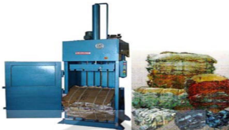
ภาพประกอบ 13 เครื่องอัดขยะของโครงการผลิตพลังงานจากขยะชุมชน
