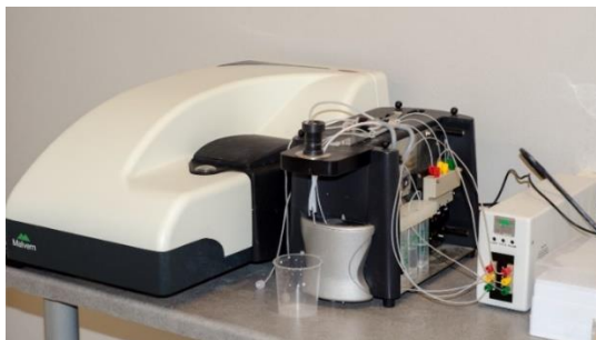
ภาพประกอบ 61 เครื่องวัดความต่างศักย์บนผิวอนุภาค (Zetasizer)
