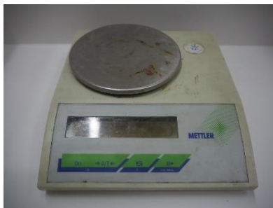
ภาพประกอบ จ เครื่องชั่ง ยี่ห้อ Mettler Type BDI201 1200g x .1g
