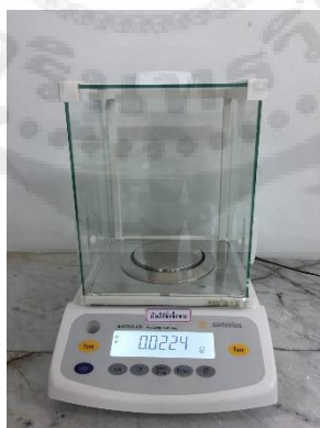
ภาพประกอบ ง เครื่องชั่งดิจิตอล ยี่ห้อ Sartorius Model BSA224S-CW 220g/0.1mg
