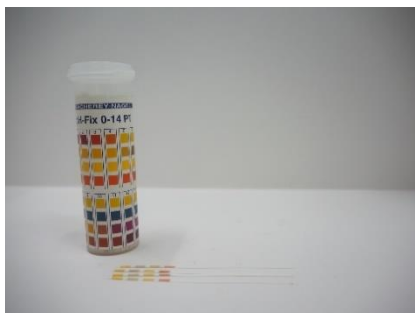
ภาพประกอบ ข กระดาษวัดค่าพีเอช (pH indicator strips)
