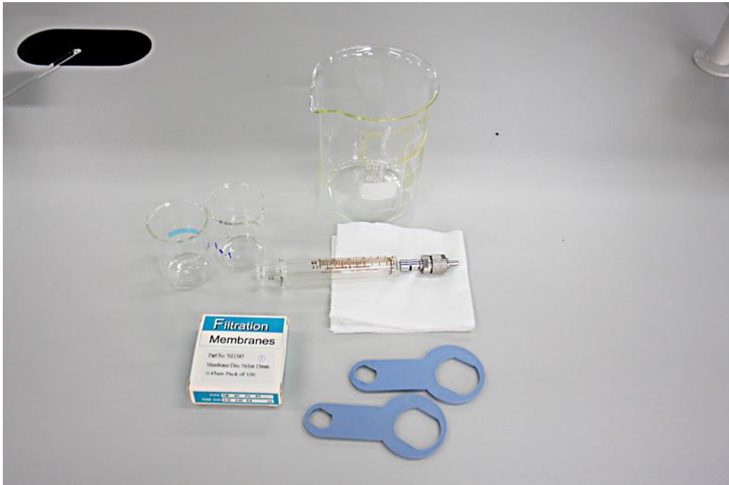
ภาพประกอบ 12 ชุดกรองที่ใช้ในการกรองสารมาตรฐานและสารตัวอย่างก่อนนำไปฉีดเข้าสู่ระบบโครมาโทกราฟีของเหลวสมรรถนะสูง
