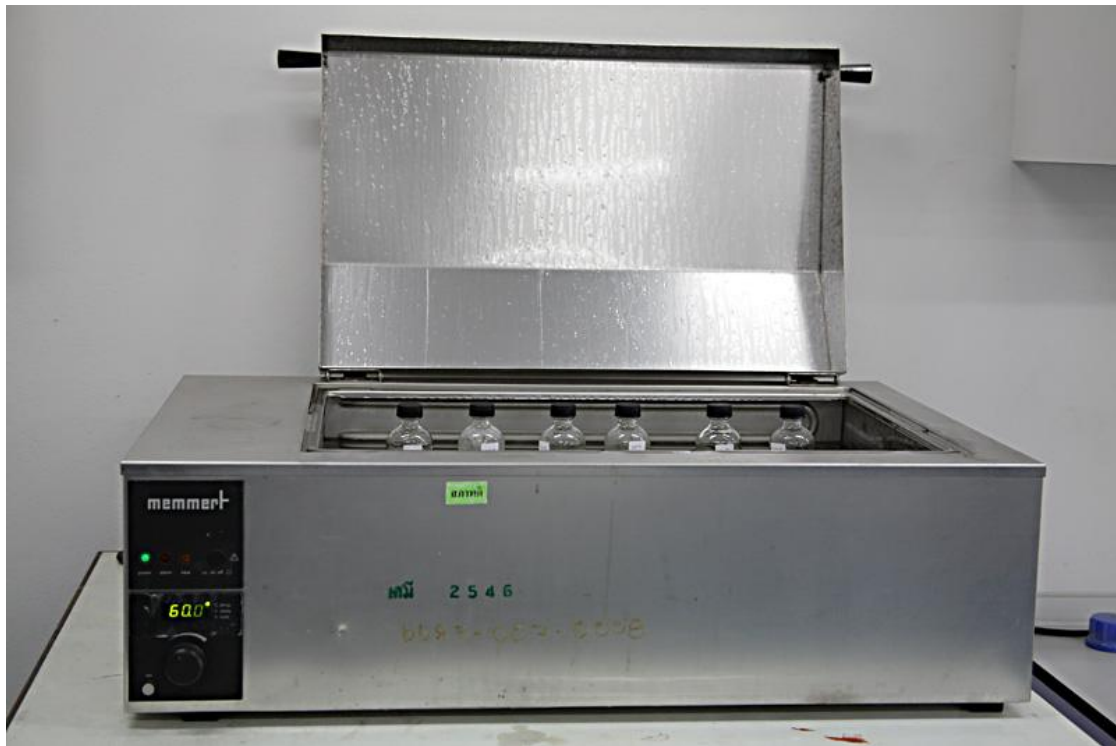
ภาพประกอบ 11 เครื่องอังน้ำที่สามารถควบคุมอุณหภูมิได้ใช้ในการให้ความร้อนแก่ระบบต้นแบบ และตัวอย่างน้ำผึ้ง
