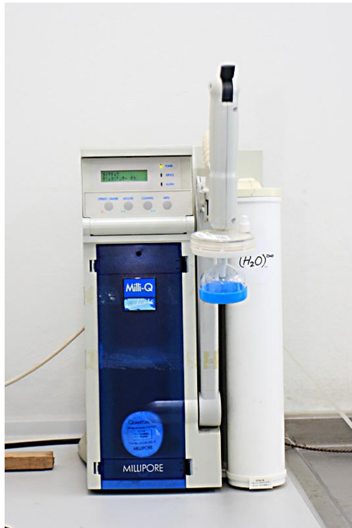
ภาพประกอบ 14 เครื่องกรองน้ำเพื่อนำมาใช้กับระบบโครมาโทกราฟีของเหลวสมรรถนะสูง
