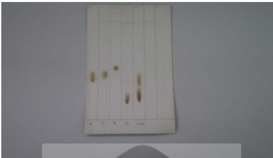
รูปที่ 5 โครมาโทแกรมของสารละลายน้ำตาลมาตรฐานและตัวอย่างขนุนที่ทดลองในระบบที่ 3.
