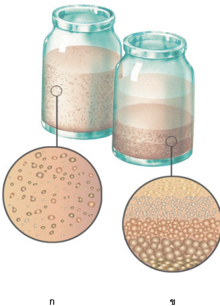
รูปภาพ 2 ก. น้ำโคลน และ ข. น้ำโคลนที่ตกตะกอน
