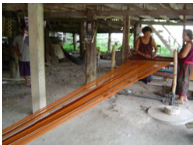
ภาพประกอบ 20 การนำด้ายมาม้วนใส่ไม้เล่ม
