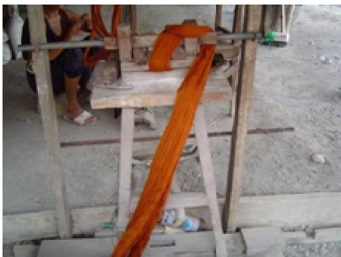
ภาพประกอบ 35 ก้อนปี่เป็นอุปกรณ์ในการหนีบด้าย
