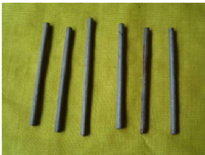
ภาพประกอบ 29 แกนด้ายทอใช้สำหรับกรอด้าย
