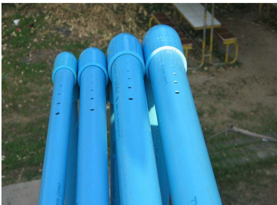
ภาพประกอบ 34 ลักษณะการเจาะรูที่ผิวของท่อไซฟอน
