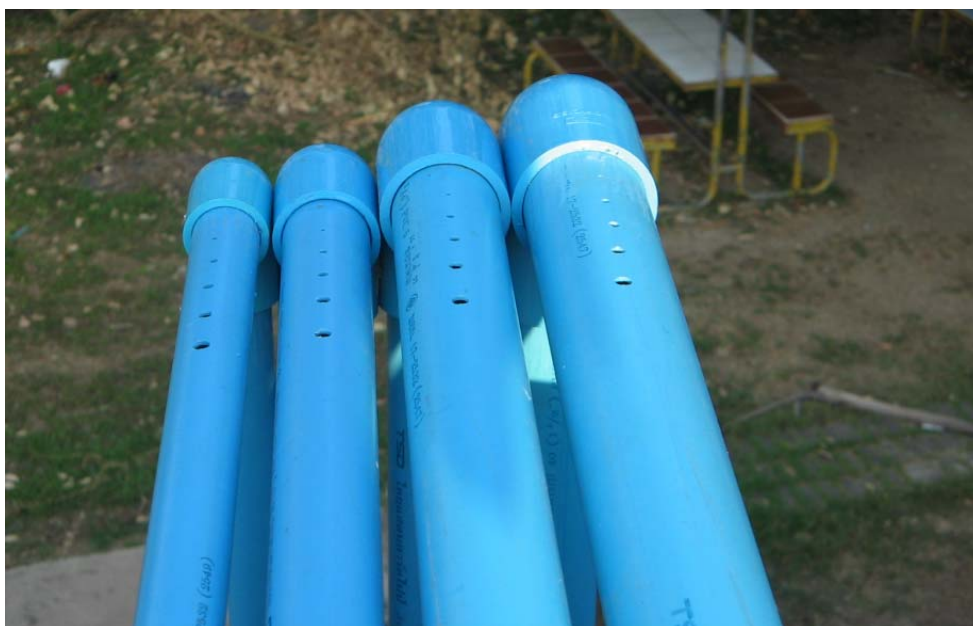
ภาพประกอบ 23 การเจาะช่องลมที่ด้านบนของท่อไซฟอน
