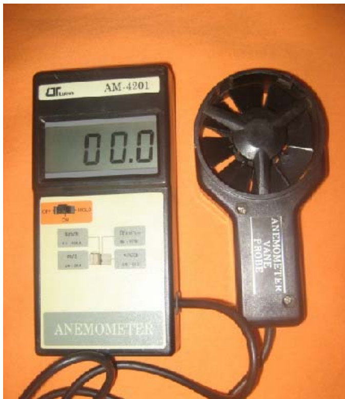
ภาพประกอบ 25 อุปกรณ์วัดอัตราเร็วลมชนิดใบพัดแสดงผลเป็นตัวเลข
