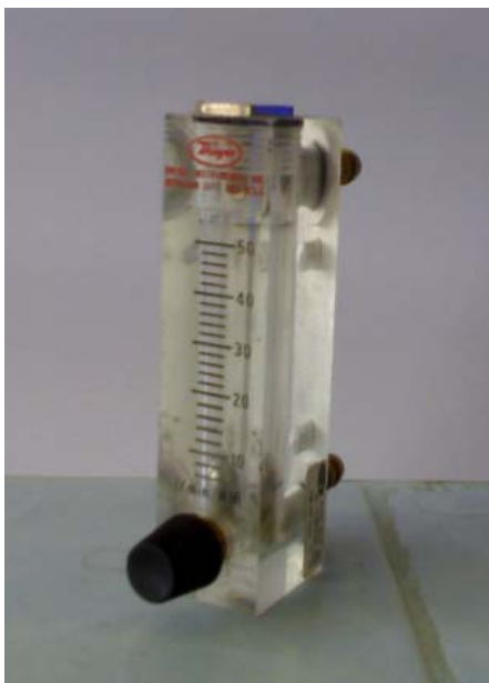
ภาพประกอบ 19 อุปกรณ์วัดอัตราการไหลอากาศชนิดโรตาริเตอร์
