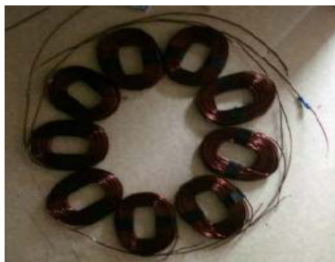
ภาพประกอบ 19 การต่อสายของขดลวดแบบสตาร์
