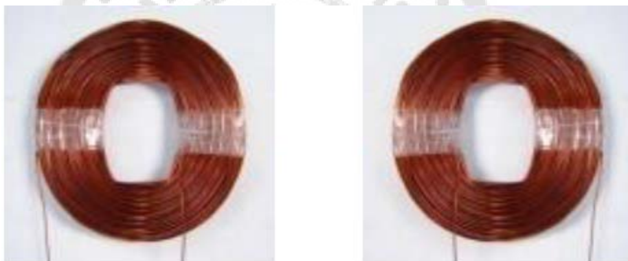
ภาพประกอบ 18 การพันขดลวดทองแดงเบอร์ 15 AWG จำนวน 60 รอบ
