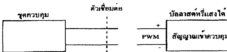
ภาพประกอบ 51 สัญญาณมอดูเลตความกว้างพัลส์ (ตัวอย่างแบบ)
