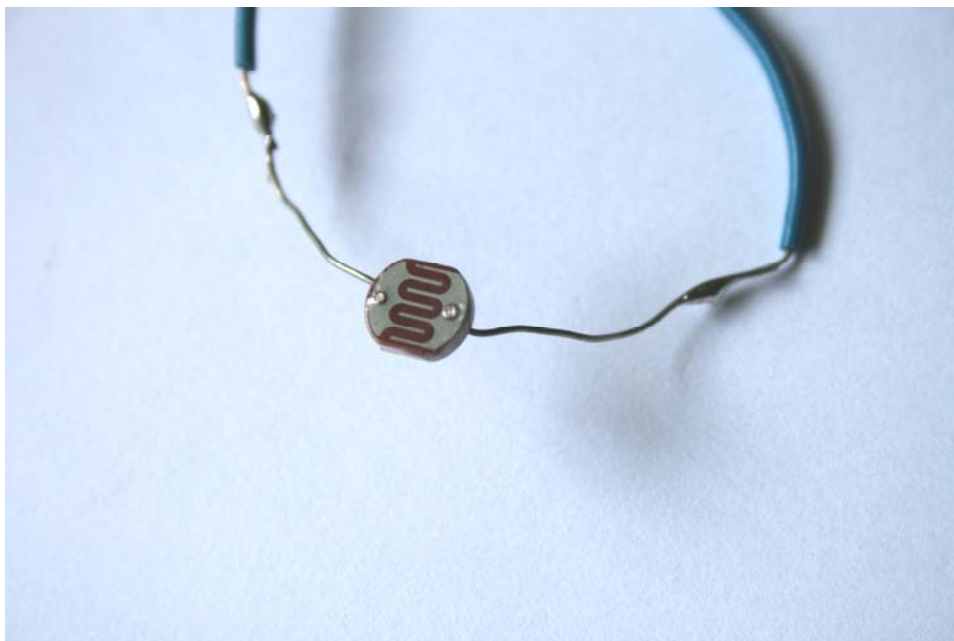
ภาพประกอบ 18 ตัวต้านทานที่ขึ้นกับความเข้มแสงหรือ LDR(light - dependent resistor)
