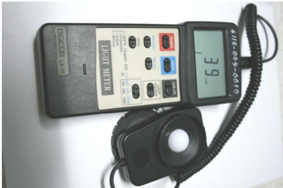
ภาพประกอบ 23 เครื่องมือวัดความเข้มแสงแบบดิจิตอล รุ่น LX – 70 ที่นำมาปรับเทียบ
