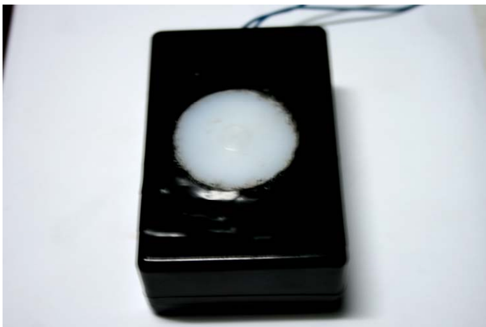
ภาพประกอบ 19 หัววัดความเข้มแสงที่สร้างขึ้นโดยใช้ตัวต้านทานที่ขึ้นต่อความเข้มแสง LDR
