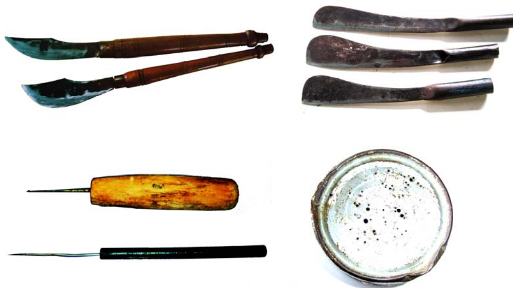
ภาพประกอบ 6 อุปกรณ์ที่ใช้ในการผลิตมิดตอก มิดโต้ เหล็กหมาดและชักเรียด
