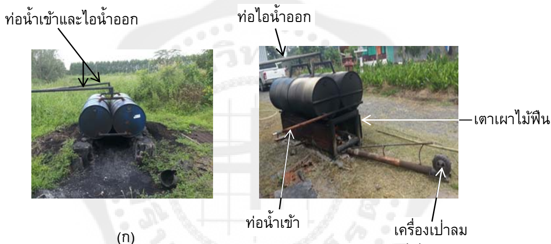
ภาพประกอบ 3 เครื่องผลิตไอน้ำแบบดั้งเดิมของกลุ่มเกษตรกร ตำบลโพธิ์แทน (ก) แบบที่ใช้ขี้เถ้า รถมขี้เถ้าเป็นเชื้อเพลิง (ข) ใช้ไม้ฟืนเป็นเชื้อเพลิง
