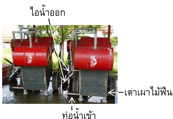
ภาพประกอบ 4 เครื่องผลิตไอน้ำแบบเคลื่อนที่ได้ ของกลุ่มเกษตรกร ตำบลหนองหมู
