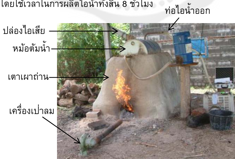
ภาพประกอบ 10 เตาเผาถ่านผลิตไอน้ำและน้ำส้มควันไม้
