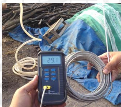
ภาพประกอบ 22 เทอร์โมมิเตอร์และสายเทอร์โมคัปเปิล Type K
