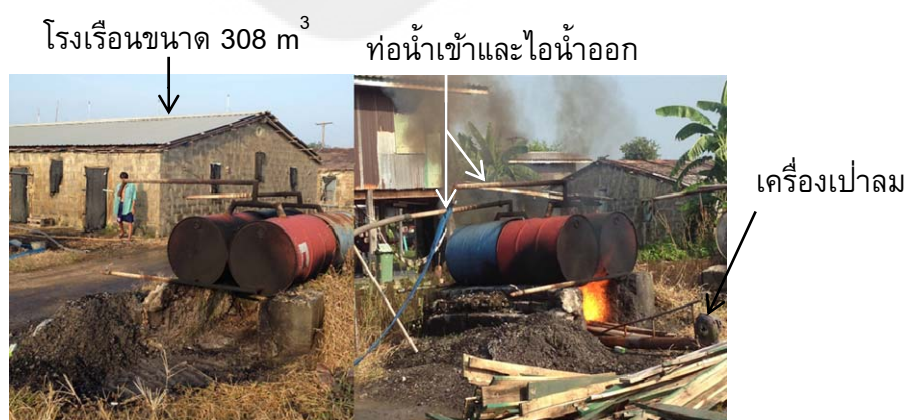
ภาพประกอบ 28 การอบฆ่าเชื้อโรงเรือนเพาะเห็ดฟางด้วยเครื่องผลิตไอน้ำด้วยเตาของชาวบ้าน
