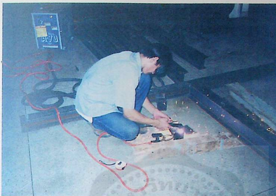
รูปที่ 4.2 ทำการตัดแผ่นเพลทตามขนาดที่กำหนด
