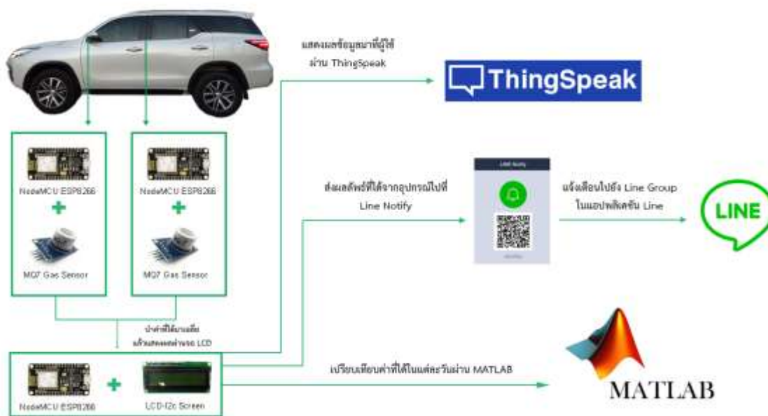
รูปที่ 3-6 แนวคิดการทำงานของระบบ
