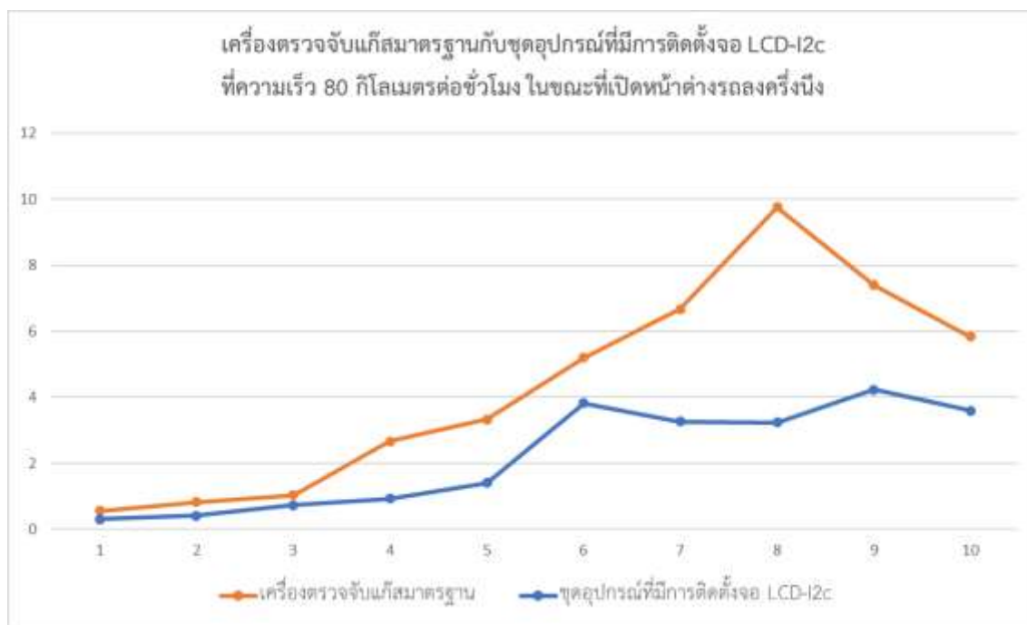
รูปที่ 4-9 กราฟแสดงการเปรียบเทียบค่าที่อ่านได้จากเครื่องตรวจจับแก๊สมาตรฐานกับชุดอุปกรณ์ที่มีการติดตั้งจอ LCD-I2c ที่ความเร็ว 80 km/h ในขณะที่เปิดหน้าต่างรถลงครึ่งนั่ง จำนวน 10 ครั้ง
