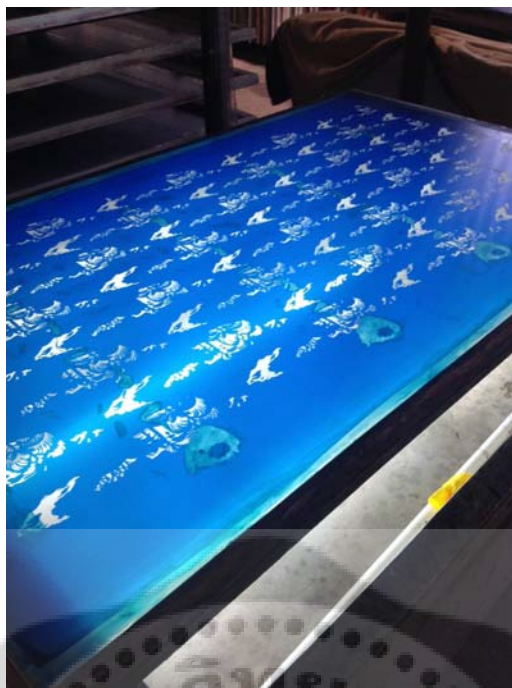
ภาพประกอบ 42 การตรวจสอบบล็อกสกรีนหลังทำการถ่ายลาย
