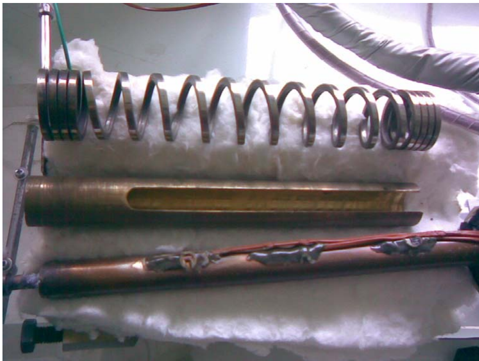
ภาพประกอบ 17 แสดงส่วนให้ความร้อนของท่อความร้อน
