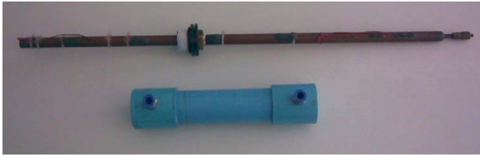
ภาพประกอบ 16 แสดงท่อความร้อนที่ติดตั้งเทอร์โมคัปเปิลแล้วกับชุดคอนเดนเซอร์
