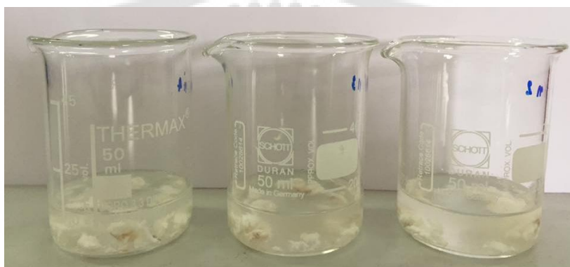
ภาพประกอบ 45 วิธีการสกัดตัวอย่างปลาด้วยวิธีทางเคมีโดยใช้ตัวทำละลายกรดไตรคลอโรแอซิดิก
