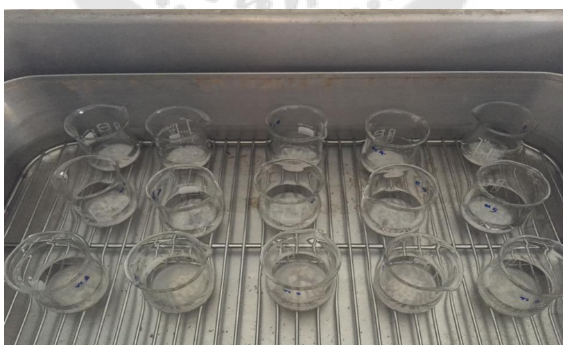
ภาพประกอบ 46 วิธีการสกัดตัวอย่างปลาด้วยวิธีทางทางกลด้วยคลื่นเสียงความถี่สูง
