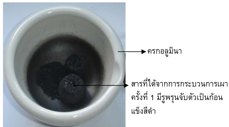
ภาพประกอบ 28 แสดงลักษณะของสารที่ได้จากการเผาครั้งที่ 1
