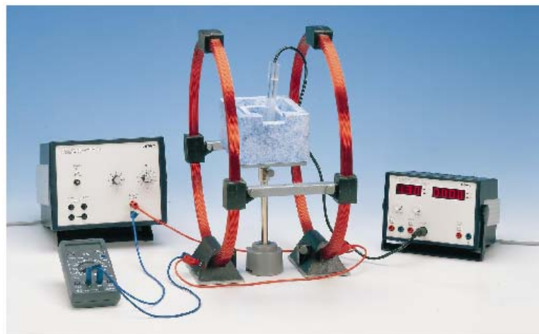
ภาพประกอบ 22 แสดงการวัดและอุปกรณ์ในการวัดค่ากระแสฮอลล์จากขดลวดเฮมโฮล์ท
