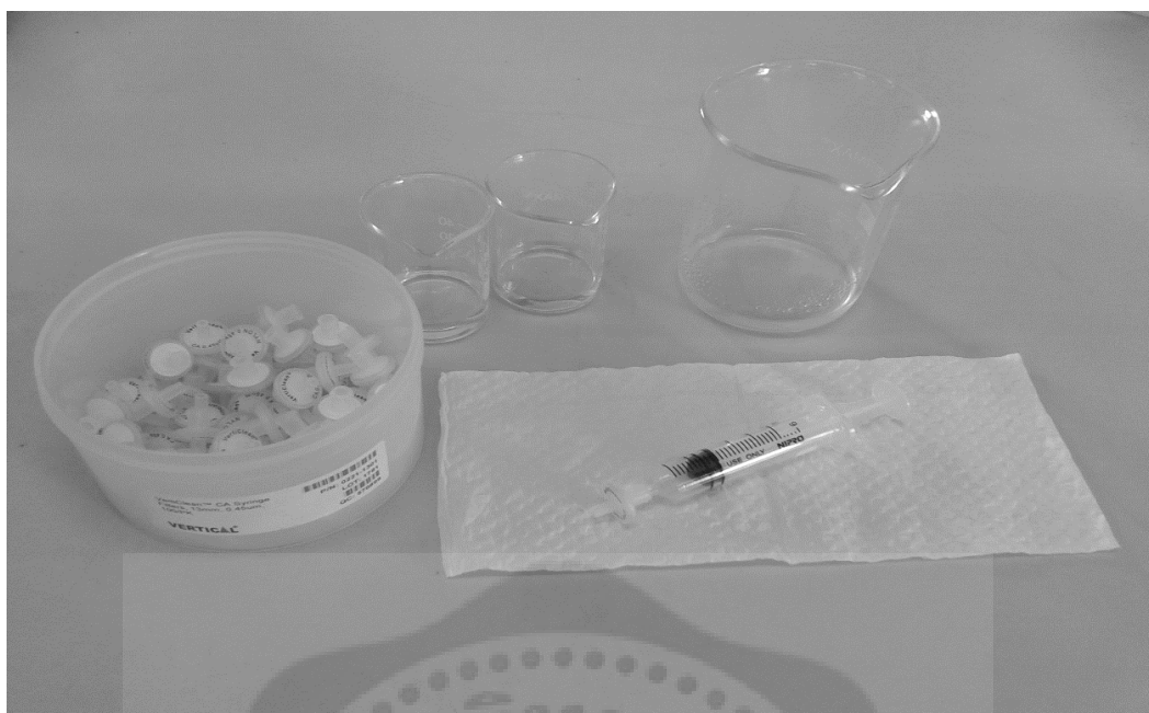
ภาพประกอบ 36 ชุดกรองที่ใช้ในการกรองสารละลายมาตรฐานและตัวอย่างก่อนฉีดเข้าสู่ระบบโครมาโทกราฟีของเหลวสมรรถนะสูง
