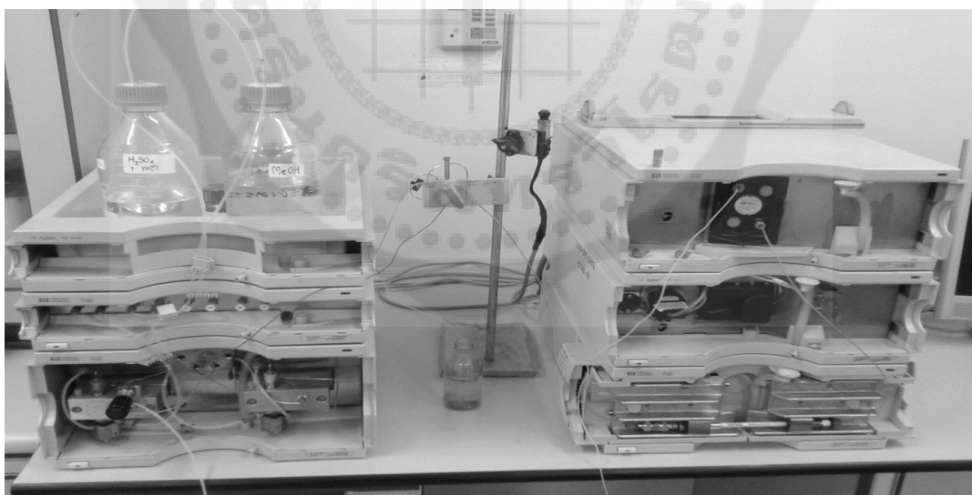
ภาพประกอบ 37 เครื่องโครมาโทกราฟีของเหลวสมรรถนะสูงและใช้ตัวตรวจวัดแบบไดโอดแอรเรย์ (จาก บริษัท Hewlett-Packard รุ่น HP 1100)
