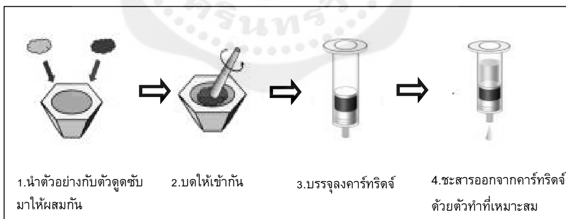
ภาพประกอบ 6 ขั้นตอนการสกัดแบบ matrix solid phase dispersion (MSPD)
