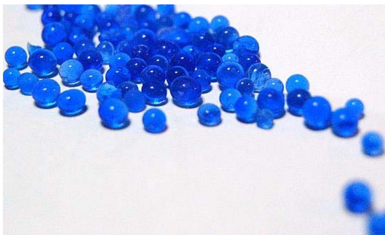
ภาพประกอบ 39 ภาพแสดงลักษณะของสารซิลิกาเจล
