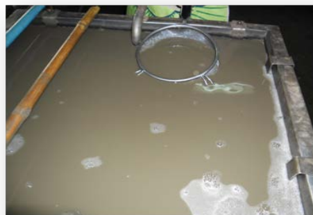
ภาพประกอบ 59 การล้างด้วยเครื่องอัลตราโซนิก
