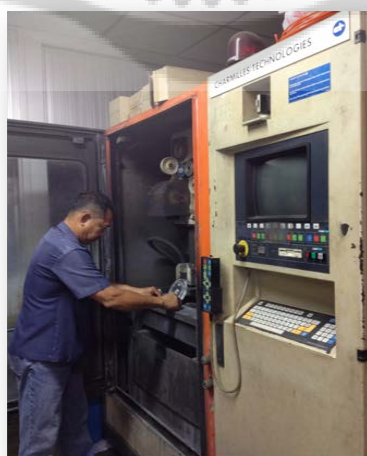
ภาพประกอบ 52 การขึ้นโมลแม่พิมพ์ปั๊มด้วยเครื่องเลเซอร์ CNC ไวร์คัท
