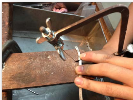
ภาพประกอบ 56 การตัดและฉลุลงบนโลหะตามแบบ
