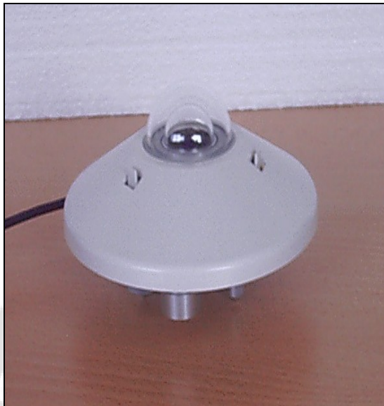
ภาพประกอบ 13 เครื่องไพราโนมิเตอร์ แบบ Thermolectric Sensor
