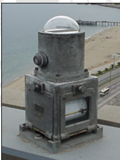
ภาพประกอบ 12 เครื่องไพราโนมิเตอร์ แบบ Thermomechanical Sensor
