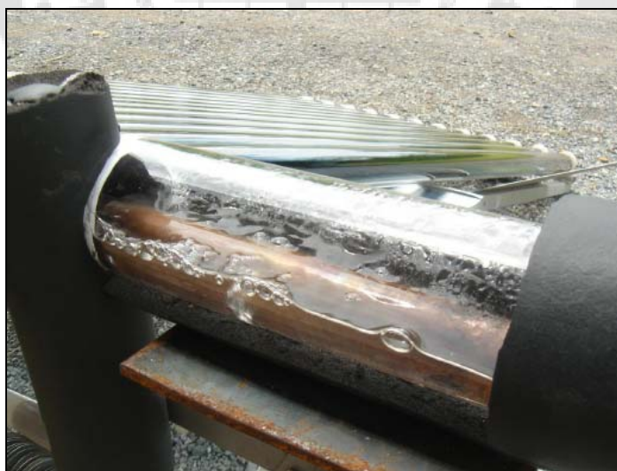
ภาพประกอบ 53 ตัวอย่างการทำน้ำร้อนของตัวเก็บรังสีอาทิตย์
