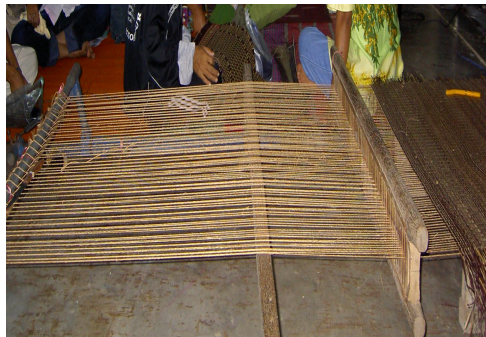
ภาพประกอบ 10 แสดงการชิงเอ็นปอบบนหูก พร้อมฟืมทอเสื่อ
