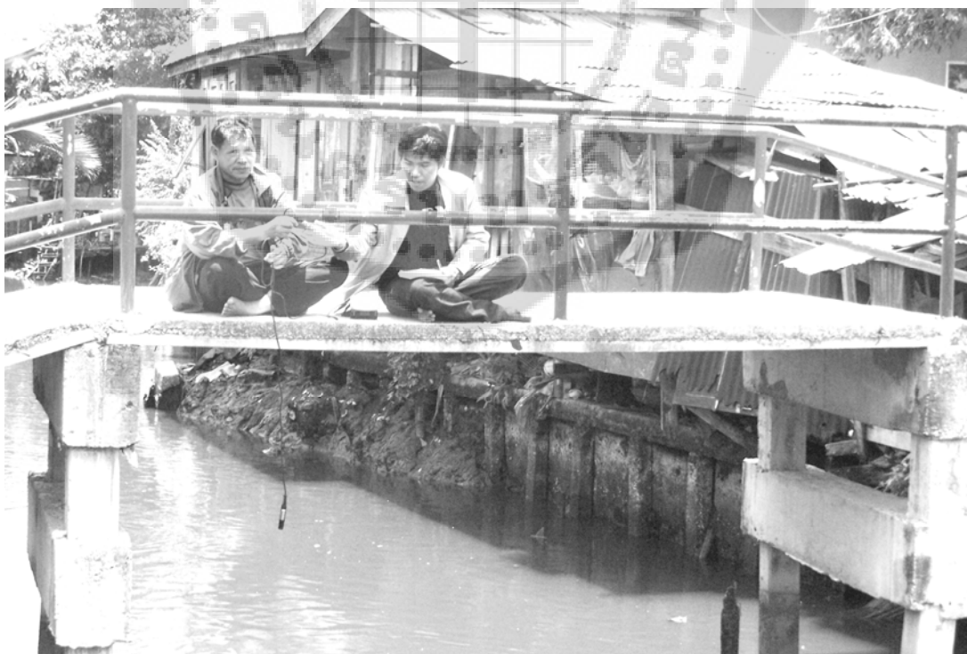
ภาพประกอบ 24 แสดงวิธีการตรวจวัดค่าอุณหภูมิ และดีไอโดยใช้เครื่องมือตรวจวิเคราะห์ออกซิเจนละลายในน้ำ DO Meter ของบริษัท YSI รุ่น 550 DO
