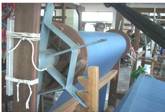
ภาพประกอบ 16 ด้ายยืนที่รวมผูกไว้ด้านบน จะนำมาใส่ใบพัดแทน เป็นลักษณะใบพัด 2 ชั้น
