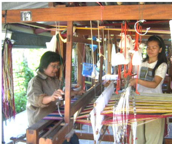
ภาพประกอบ 2 การทอผ้ายกมุกโดยคนที่ 1 เป็นคนพุ่งด้าย และคนที่ 2 เป็นคนช่วยยกตะกอก
