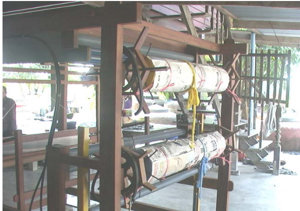
ภาพประกอบ 17 ใบพัดด้ายยืน และเฟืองเพลลาม้วนเก็บผ้าที่สร้างและปรับปรุงใหม่
