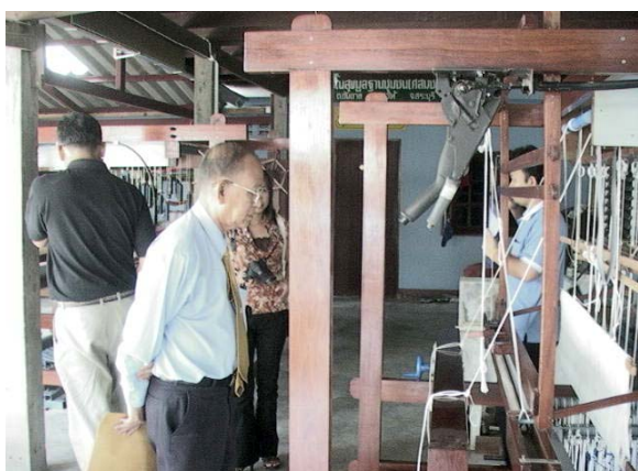
ภาพประกอบ 20 การทอผ้ายกมุก 6 ตะกอล โดยใช้ที่พัฒนาแล้วของ ดวง ทองคำชูย (ม้าเหยียบแบบชุด)
