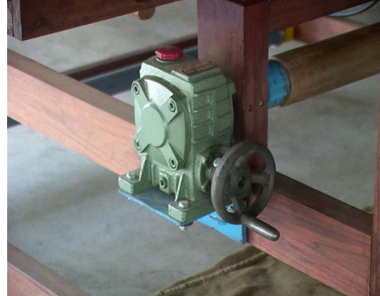
ภาพประกอบ 17 ใบพัดด้ายยืน และเฟืองเพลลาม้วนเก็บผ้าที่สร้างและปรับปรุงใหม่
