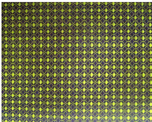
ภาพประกอบ 37 ลายผ้ายกมุก 6 ตะกอล และรหัสผ้าเหียบแบบชุดเริ่มจาก 1-8, 7-2, 1-8, และ 7-2 โดยกลุ่มรหัส ผ้าเหียบที่ผูกตะกอล 2-4-5, 1-3-5-6, 2-3-6, 1-2-3,-4, 1-5, 1-2-6 และ 1-2-3-4-5
