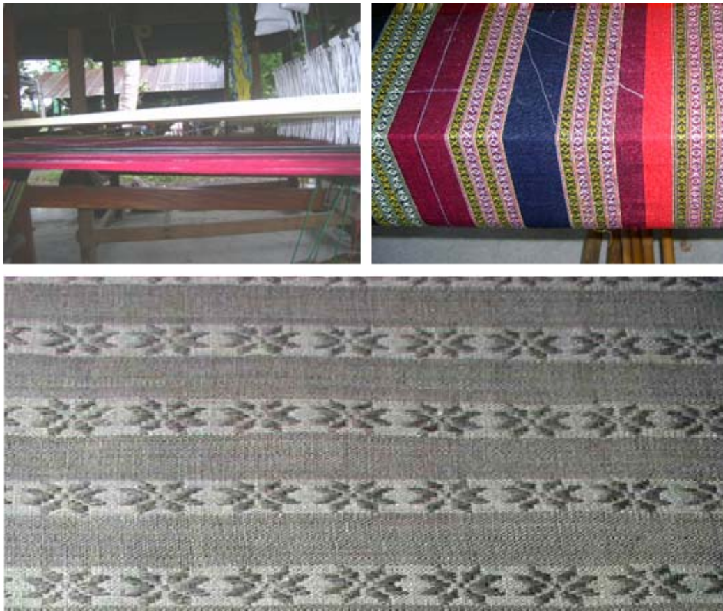
ภาพประกอบ 3 การทอผ้ายกมุกจะต้องใช้ด้ายยืน 2 ชั้น และลักษณะรูปแบบการทอ
