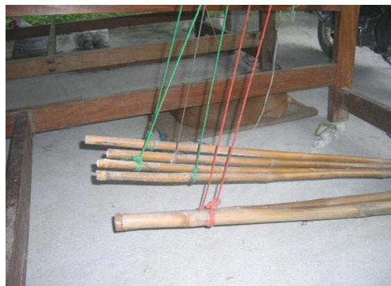
ภาพประกอบ 19 การทอผ้ายกมุก 6 ตะกอล โดยใช้กี่ของชุมชน (ม้าเหยียบอิสระ)
