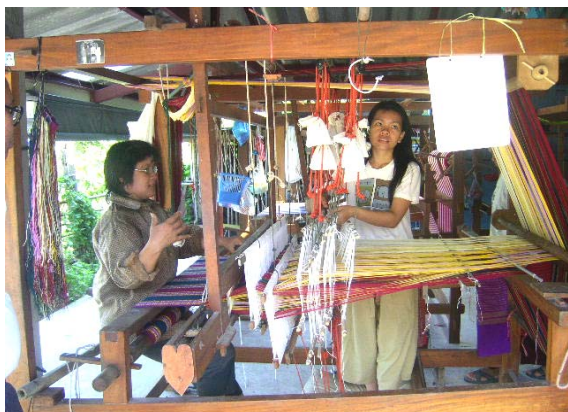
ภาพประกอบ 19 การทอผ้ายกมุก 6 ตะกอล โดยใช้กี่ของชุมชน (ม้าเหยียบอิสระ)
