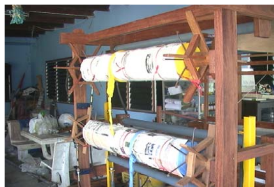
ภาพประกอบ 16 ด้ายยืนที่รวมผูกไว้ด้านบน จะนำมาใส่ใบพัดแทน เป็นลักษณะใบพัด 2 ชั้น
