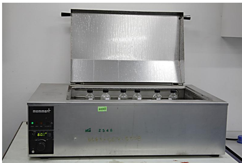
ภาพประกอบ 29 อ่างน้ำร้อนที่ใช้ศึกษาผลของระยะเวลาในการเวลาให้ความร้อนด้วยน้ำเดือด
