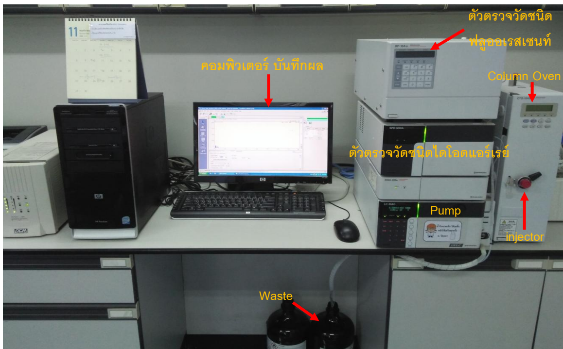
ภาพประกอบ 12 เครื่องโครมาโทกราฟีของเหลวสมรรถนะสูง (HPLC) รุ่น LC-20A
