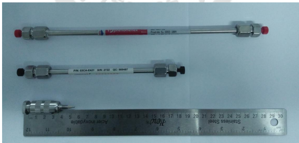
ภาพประกอบ 13 เปรียบเทียบขนาดของความยาวคอลัมน์
