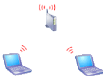
ภาพประกอบ 14 ระบบเครือข่ายไร้สายเชื่อมต่อแบบกลุ่มโครงสร้าง (Infrastructure)
