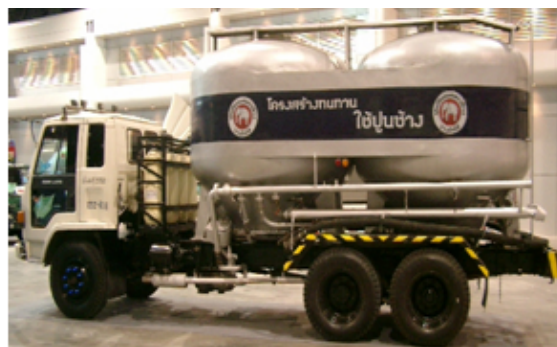
ภาพประกอบ 2 รถบรรทุกปูนซีเมนต์ฝง 10 ล้อ และ 18 ล้อที่ปรับมาใช้ก๊าซ NGV
