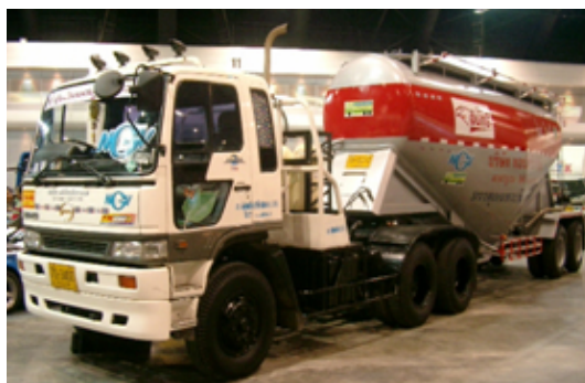
ภาพประกอบ 2 รถบรรทุกปูนซีเมนต์ฝง 10 ล้อ และ 18 ล้อที่ปรับมาใช้ก๊าซ NGV
