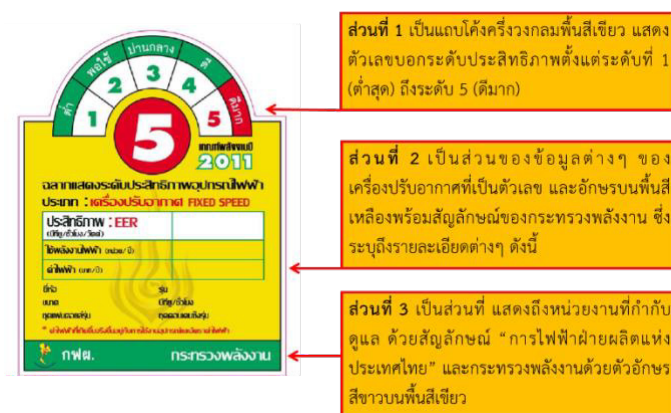
รูปที่ 7.30 ตัวอย่างฉลากประหยัดไฟฟ้าเบอร์ 5 เครื่องปรับอากาศ (แบบเก่า)
