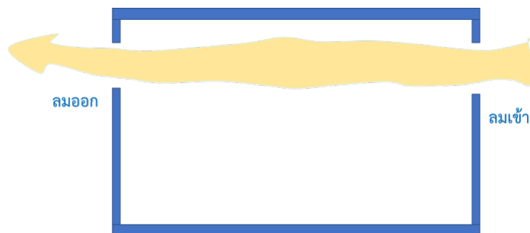
รูปที่ 7.21 ขนาดช่องทางเข้าของลมเท่ากับช่องทางออกของลม อยู่แนวเดียวกันด้านบนห้อง
