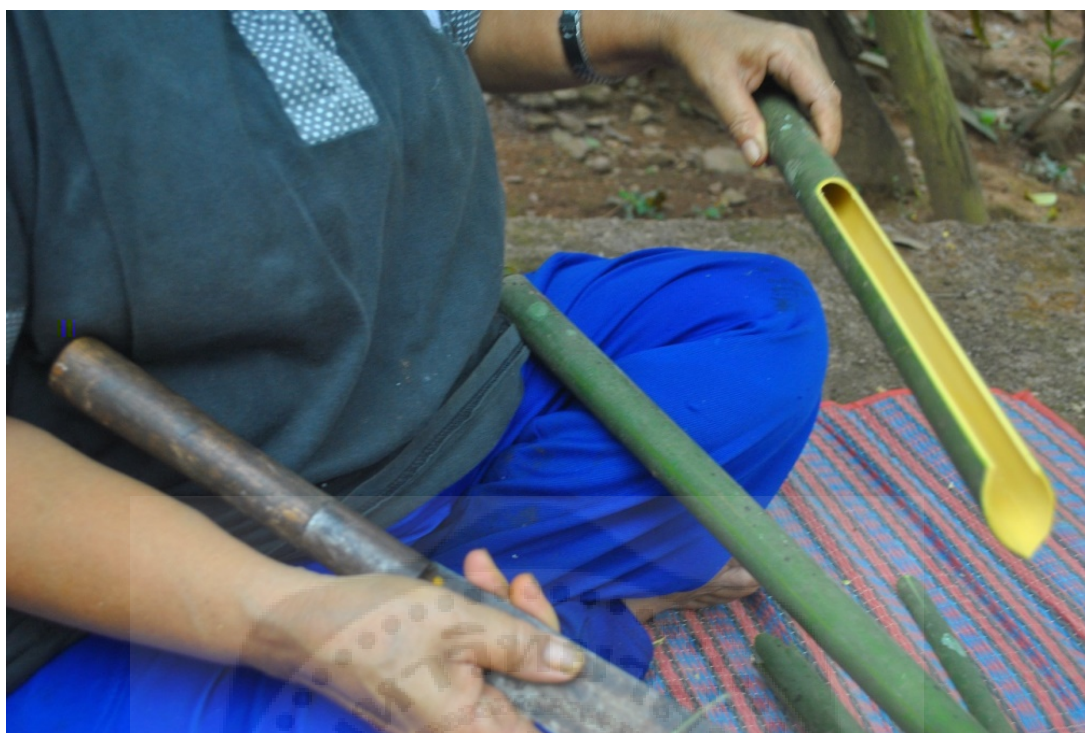
ภาพประกอบ 15 ฝานเนื้อไม้และตัดส่วนปลายเป็นทรงปากฉลาม ถ่ายเมื่อวันที่ 17 ตุลาคม 2557
