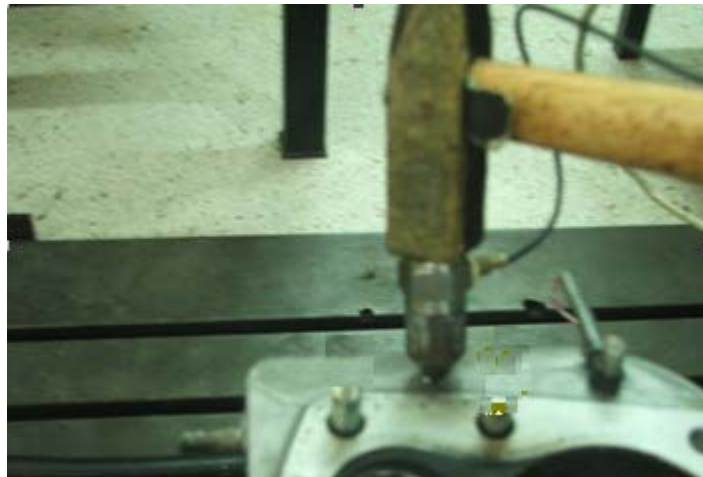
ภาพประกอบ 66 การติดตั้งหัวรับสัญญาณกับเสื่อสูบและค้อนเคาะ
