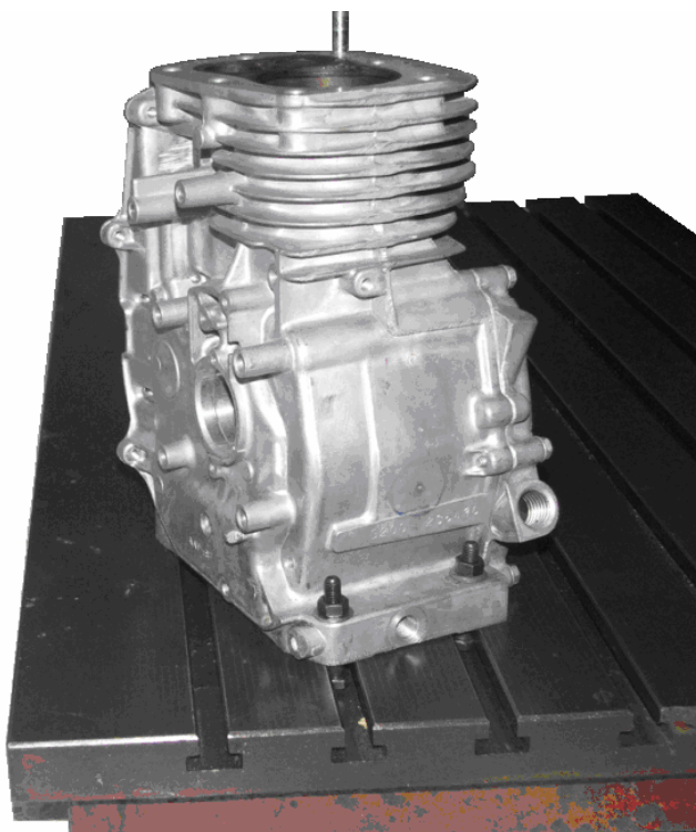
ภาพประกอบ 30 ภาพถ่ายการยึดฐานของเสื่อสูบติดกับแท่นเหล็ก
