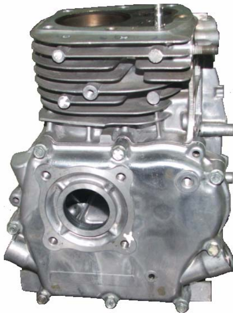
ภาพประกอบ 26 ภาพถ่ายเสื้อสูบเครื่องยนต์แก๊สโซลีนสูบเดี่ยว
