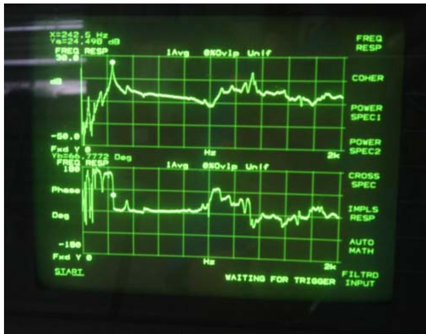
ภาพประกอบ 65 การตอบสนองความถี่ของชุดส่งและรับสัญญาณ
