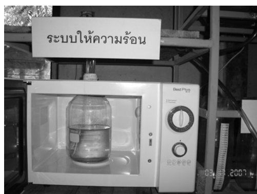
ภาพประกอบ 14 แสดงชุดให้ความร้อนแก่น้ำมันด้วยคลื่นไมโครเวฟและทำปฏิกิริยา
