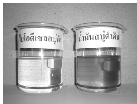
ภาพประกอบ 39 แสดงการเปรียบเทียบระหว่างไบโอดีเซลจากสบู่ดำโดยกระบวนการทรานส์เอสเทอริฟิเคชันและให้ความร้อนด้วยไมโครเวฟกับน้ำมันสบู่ดำดิบ
