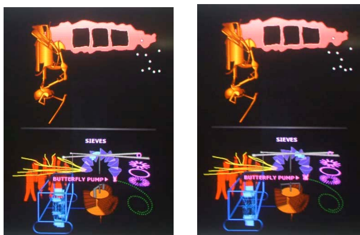
ภาพประกอบ 85 ภาพแสดงการไหลของแก๊ส ใน Sieves ไปยัง Butterfly Pump
