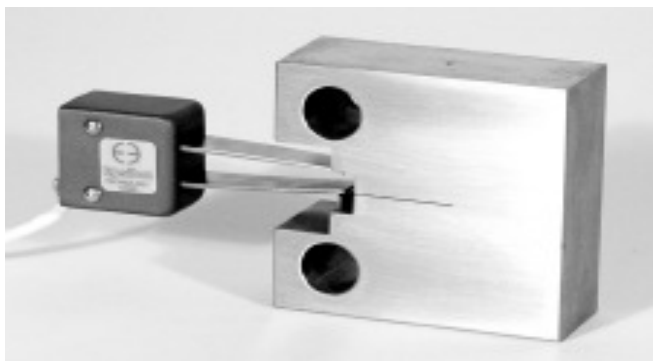
ภาพประกอบ 10 Clip – On Extensometer และลักษณะการติดตั้งบนชิ้นทดสอบ
