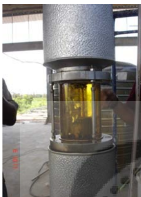
ภาพประกอบ 8 น้ำมันแปรรูปจากขยะที่ผ่านการกลั่นและการติดไฟ
