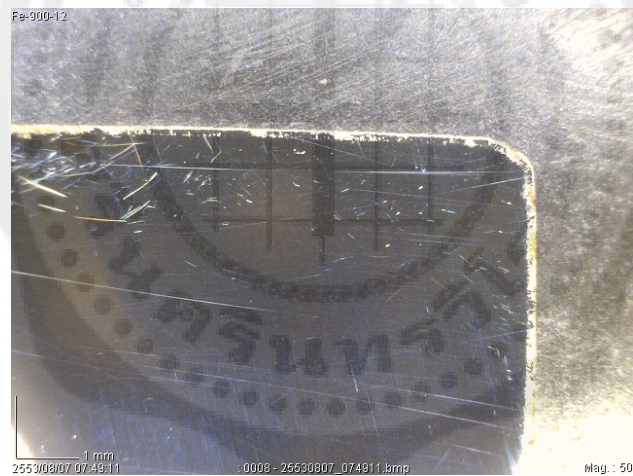
รูปภาคผนวกที่ 2 ชิ้นงานหลังเคลือบที่ 900 องศาเซลเซียสเป็นเวลา 12 ชั่วโมง
