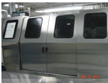
ภาพประกอบ 23 แสดงเครื่องตัดและเจียระไนแผ่นเวเฟอร์
