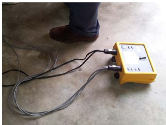
ภาพประกอบ 23 การเสียบสายวัดค่าเข้าเครื่องบันทึกค่าพลังงานไฟฟ้า 3 เฟส
