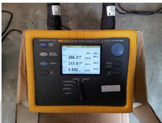
ภาพประกอบ 19 เครื่องบันทึกค่าพลังงานไฟฟ้า 3 เฟส
