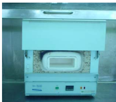
ภาพประกอบ 11 เตาเผาสำหรับทดสอบเถ้าและกากซัลเฟต ที่มา : ห้องปฏิบัติการ บริษัทวิทยาคอร์ป โปรดักส์ จำกัด. (20 มกราคม 2547)
