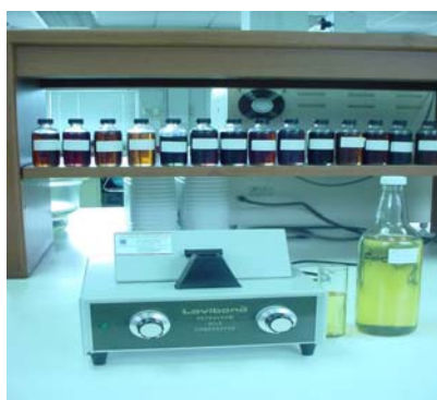
ภาพประกอบ 12 เครื่องทดสอบความเข้มของสี (Petroleum Colorimeter) ที่มา : ห้องปฏิบัติการ บริษัทวิทยาคอร์ป โปรดักส์ จำกัด. (20 มกราคม 2547)
