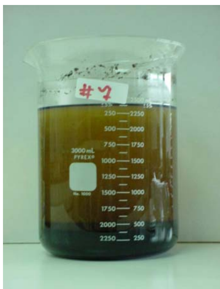
ภาพประกอบ 27 น้ำมันตัวอย่างหลังเติมดินเหนียวและทิ้งให้ตกตะกอน
