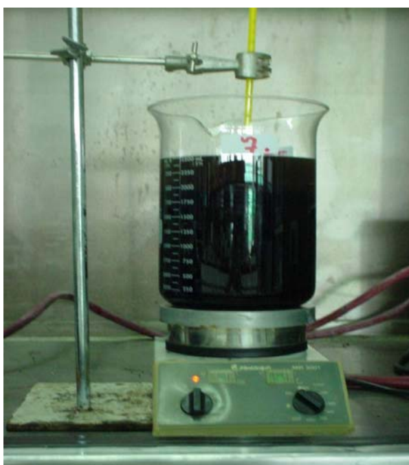
ภาพประกอบ 23 การต้มเพื่อแยกน้ำและตะกอน
