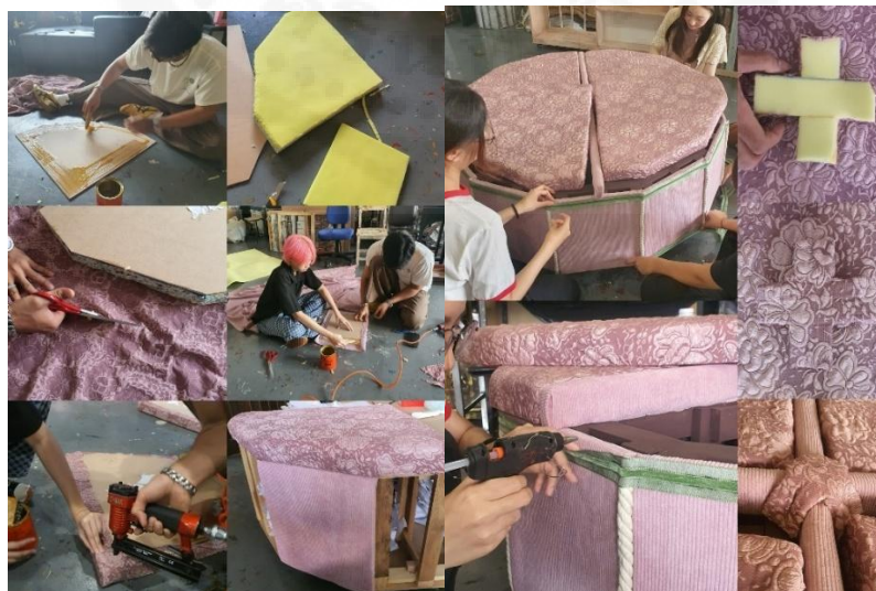
ภาพที่ 3.45 : ภาพขั้นตอนการติดฟองน้ำและหุ้มผ้าโซฟา ที่มา : ผู้ศึกษา
