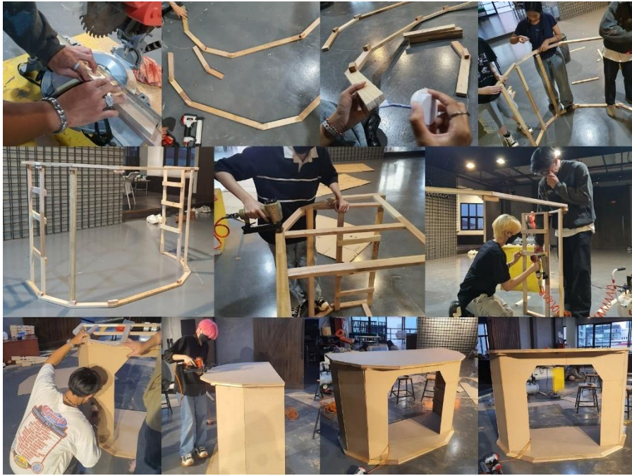
ภาพที่ 3.48 : ภาพขั้นตอนการทำโครงสร้างของเตาผิง ที่มา : ผู้ศึกษา
