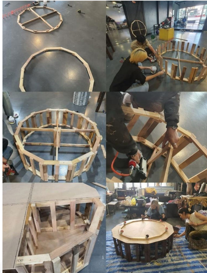
ภาพที่ 3.44 : ภาพขั้นตอนการทำโครงสร้างของโซฟา ที่มา : ผู้ศึกษา
