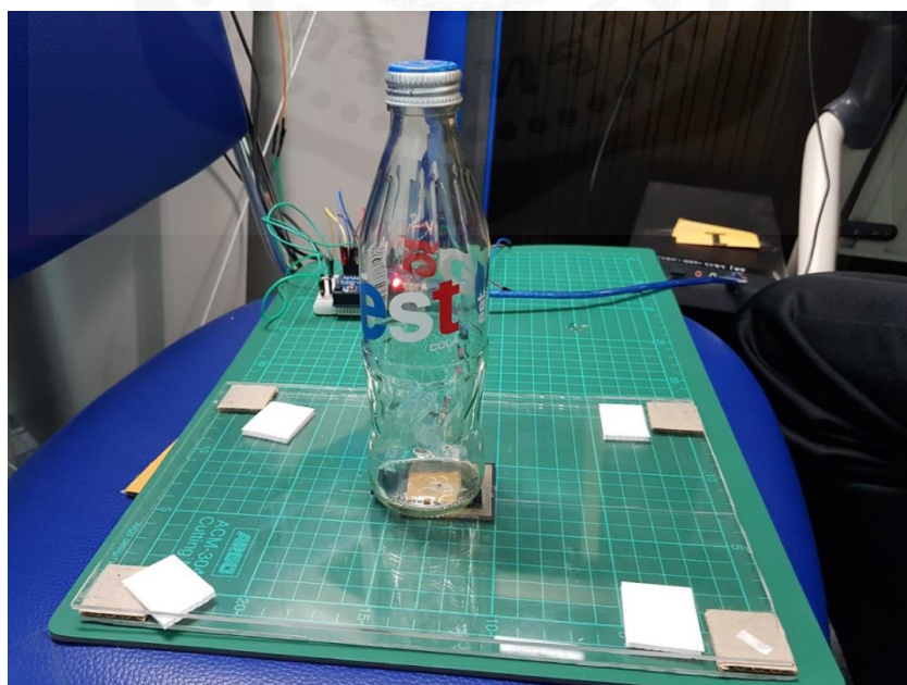
ภาพที่ 20 : การทดลองการใช้ Force Sensitive Resistor มาใช้ในการวัดน้ำหนักแทน Loadcell
