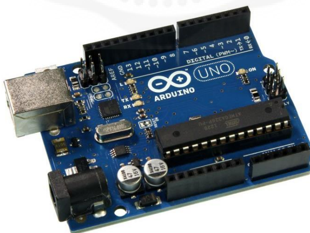
ภาพที่ 5 : Arduino Uno R3
