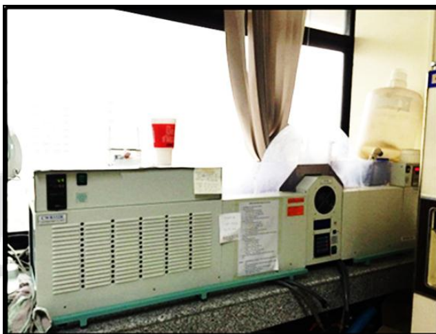
ภาพประกอบ 10 เครื่องแช่สลับน้ำร้อนน้ำเย็น (Thermo Cycling Unit)
