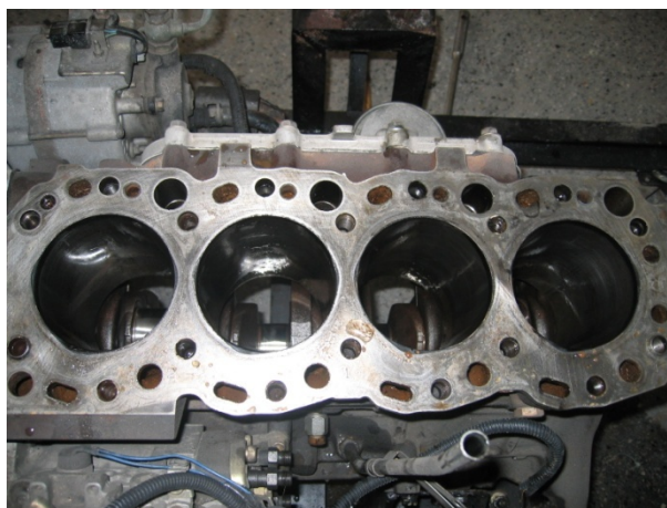
ภาพประกอบ 58 แสดงความสะอาดในห้องเผาไหม้ก่อนทดสอบน้ำมันดีเซล
