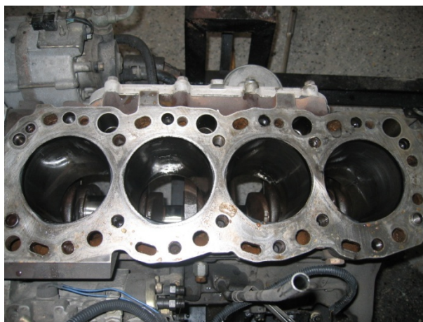
ภาพประกอบ 60 แสดงความสะอาดในห้องเผาไหม้ก่อนการทดสอบน้ำมันดีเซลผสมก๊าซแอลพีจี
