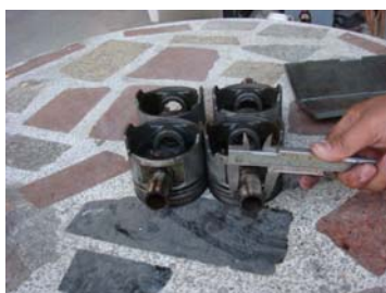
ภาพประกอบ 57 การวัดขนาดของสลักลูกสูบ
