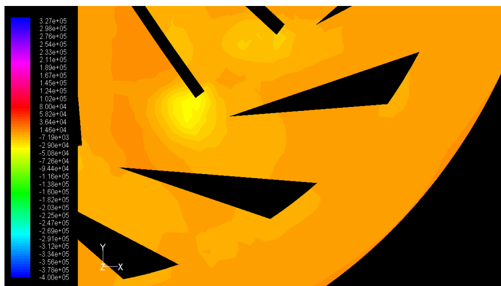
ภาพประกอบ 159 แสดงระดับชั้นความดัน แบบแผ่นเรียบสามเหลี่ยมมุมฉก 27^\circ ตำแหน่งที่ 1
