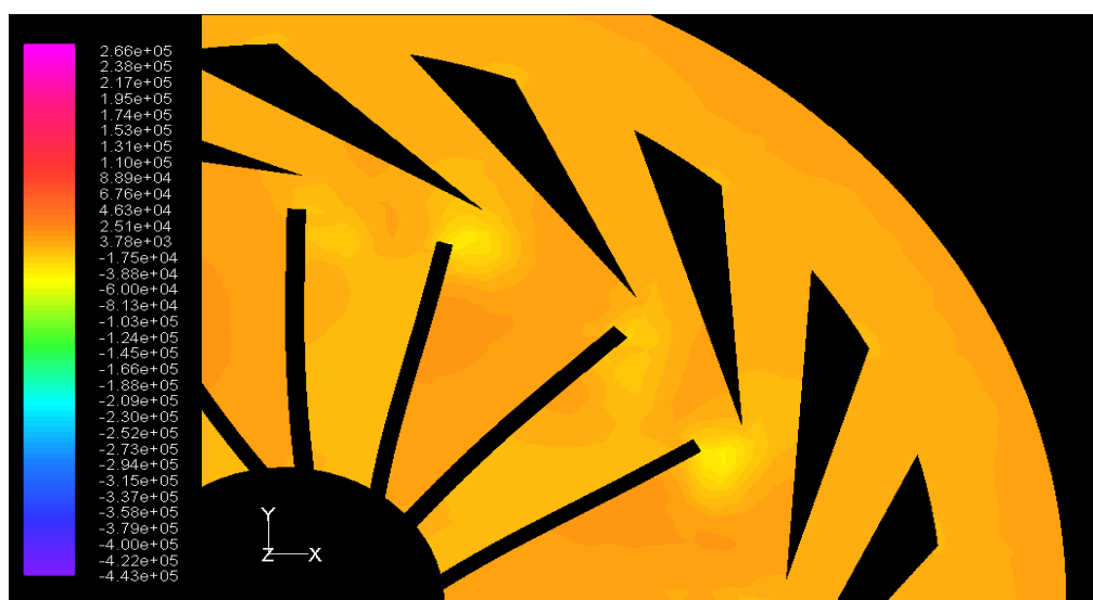
ภาพประกอบ 135 แสดงระดับชั้นความดัน แบบแผ่นเรียบสามเหลี่ยมมุมลู่ 18^\circ ตำแหน่งที่ 2
