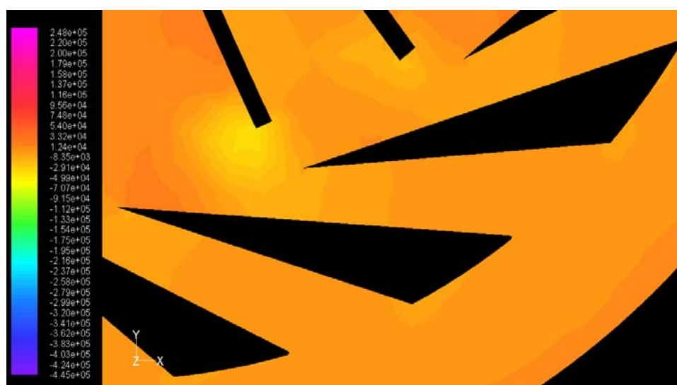
ภาพประกอบ 123 แสดงระดับชั้นความดัน แบบแผ่นเรียบสามเหลี่ยมมุมสูง 15^\circ ตำแหน่งที่ 1
