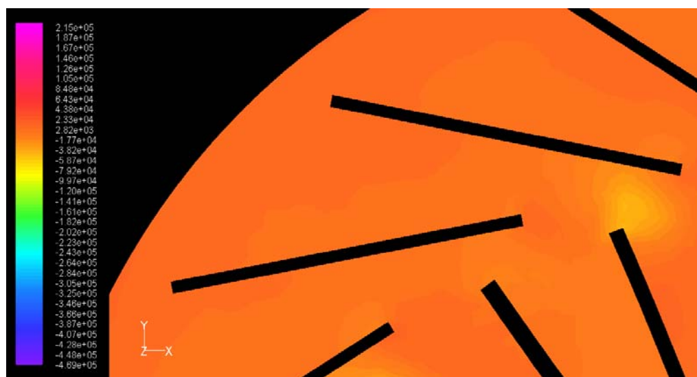
ภาพประกอบ 99 แสดงระดับชั้นความดัน แบบแผ่นครีบลำตรงมุม 21^\circ ตำแหน่งที่ 2
