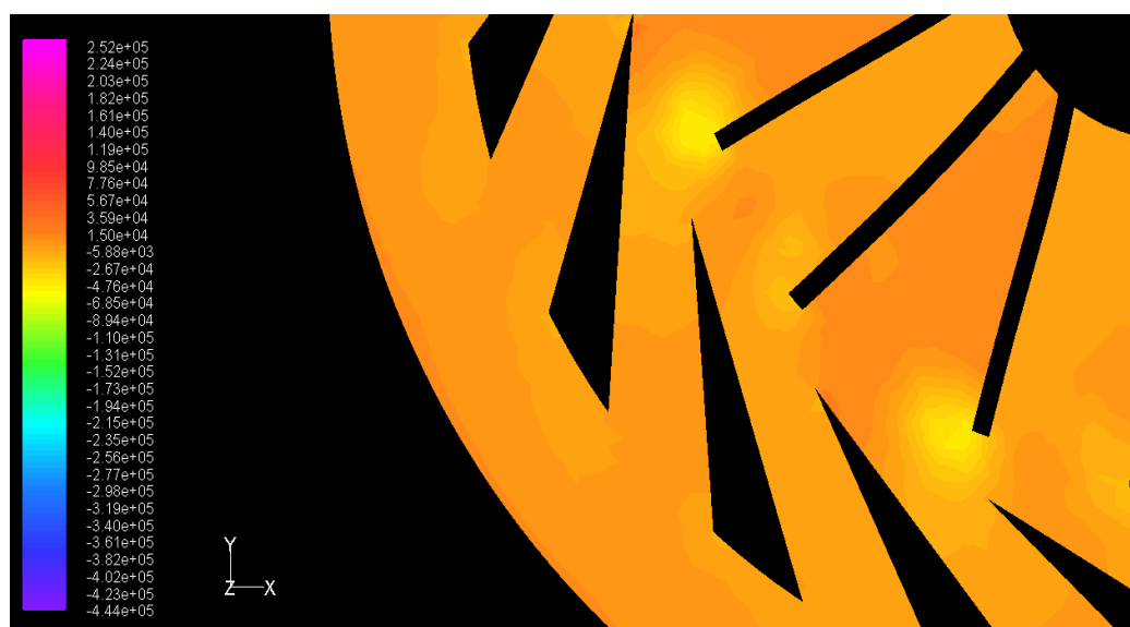
ภาพประกอบ 147 แสดงระดับชั้นความดัน แบบแผ่นเรียบสามเหลี่ยมมุมฉั่ว 21° ตำแหน่งที่ 3
