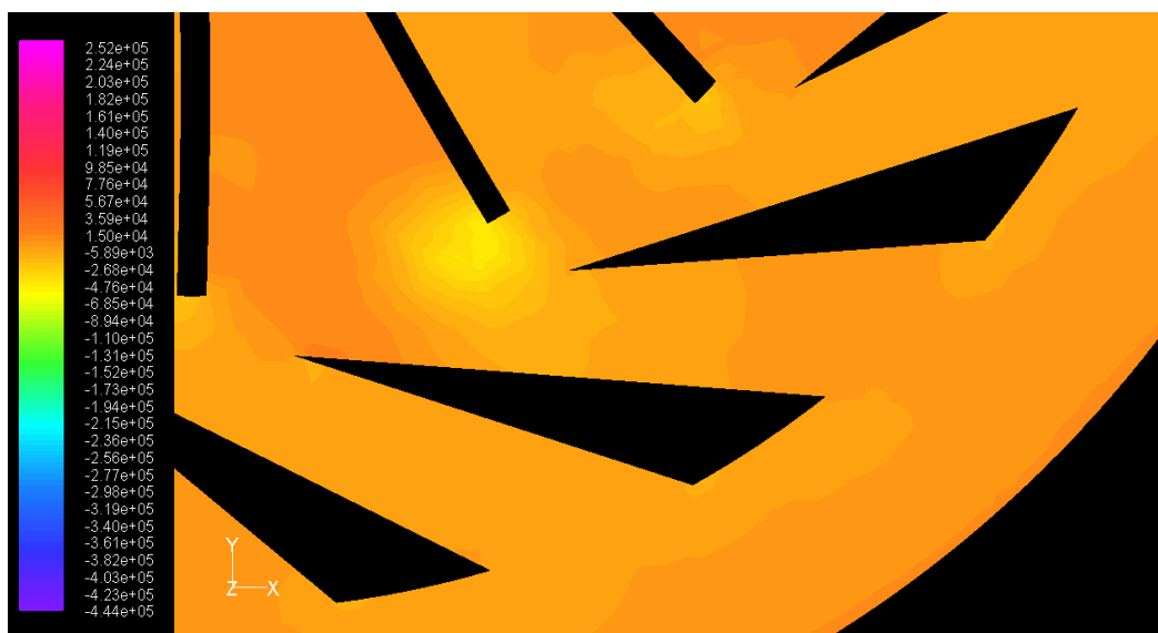
ภาพประกอบ 141 แสดงระดับชั้นความดัน แบบแผ่นเรียบสามเหลี่ยมมุมฉั่ว 21° ตำแหน่งที่ 1
