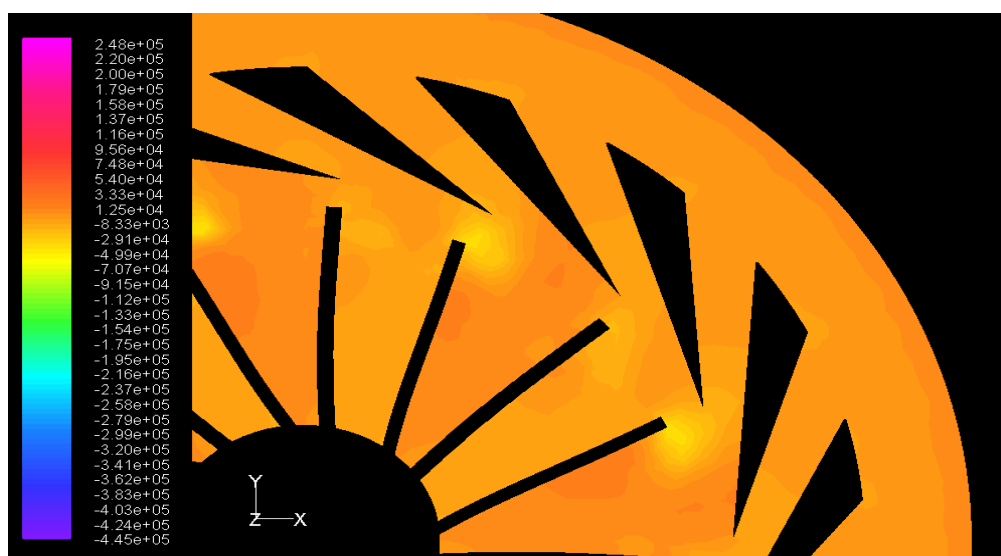
ภาพประกอบ 126 แสดงระดับชั้นความดัน แบบแผ่นเรียบสามเหลี่ยมมุมสูง 15^\circ ตำแหน่งที่ 2
