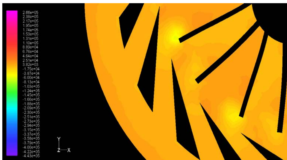
ภาพประกอบ 138 แสดงระดับชั้นความดัน แบบแผ่นเรียบสามเหลี่ยมมุมฉก 18^\circ ตำแหน่งที่ 3
