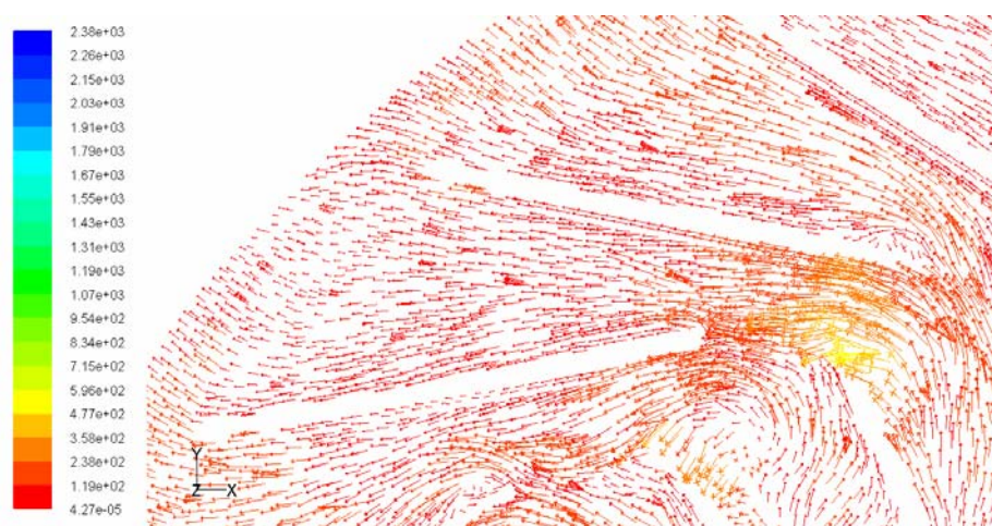
ภาพประกอบ 107 แสดงเส้นการไหล แบบแผ่นคريبตรงมุม 24^\circ ตำแหน่งที่ 2
