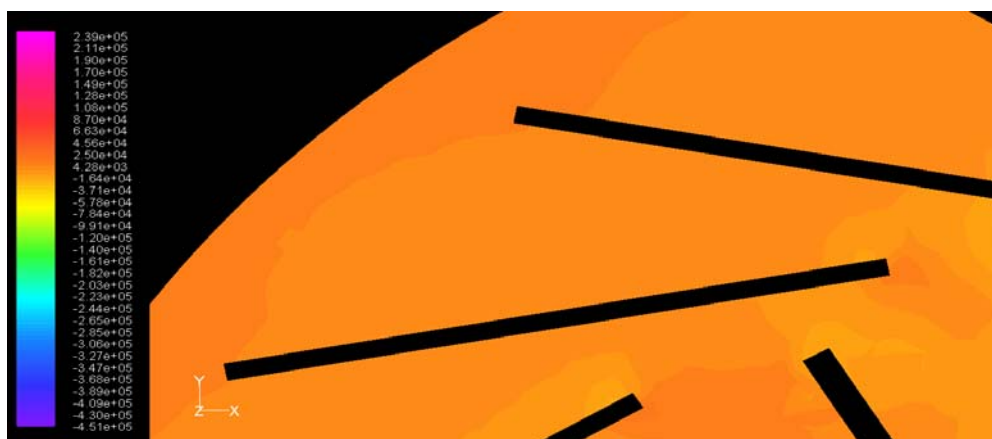
ภาพประกอบ 81 แสดงระดับชั้นความดัน แบบแผ่นคريبตรงมุม 15^\circ ตำแหน่งที่ 2
