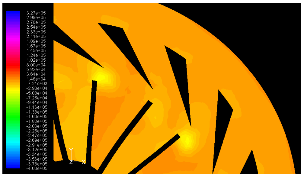
ภาพประกอบ 162 แสดงระดับชั้นความดัน แบบแผ่นเรียบสามเหลี่ยมมุมลู่ 27^\circ ตำแหน่งที่ 2
