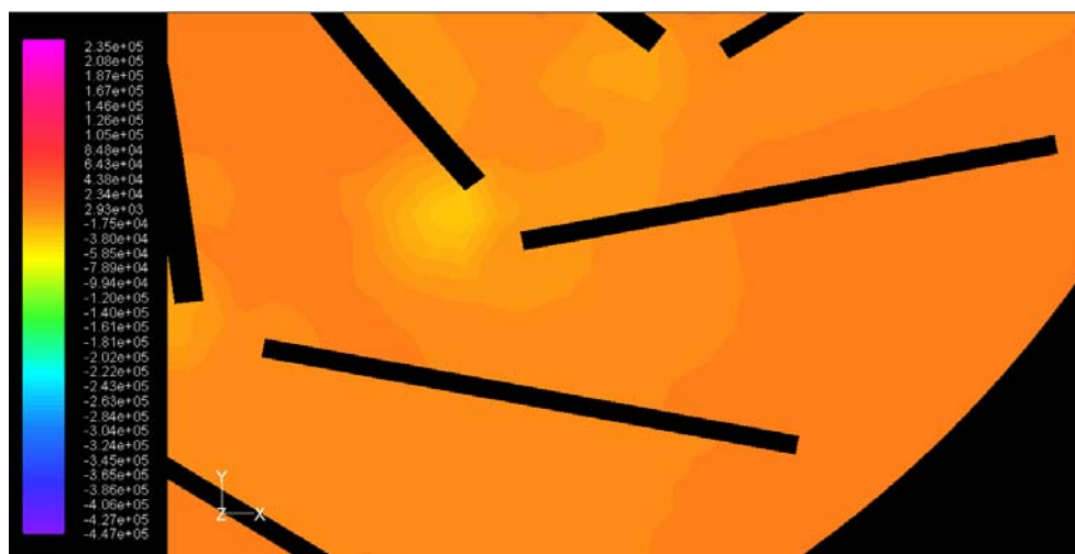
ภาพประกอบ 114 แสดงระดับชั้นความดัน แบบแผ่นครีบริดตรงมุม 27^\circ ตำแหน่งที่ 1
