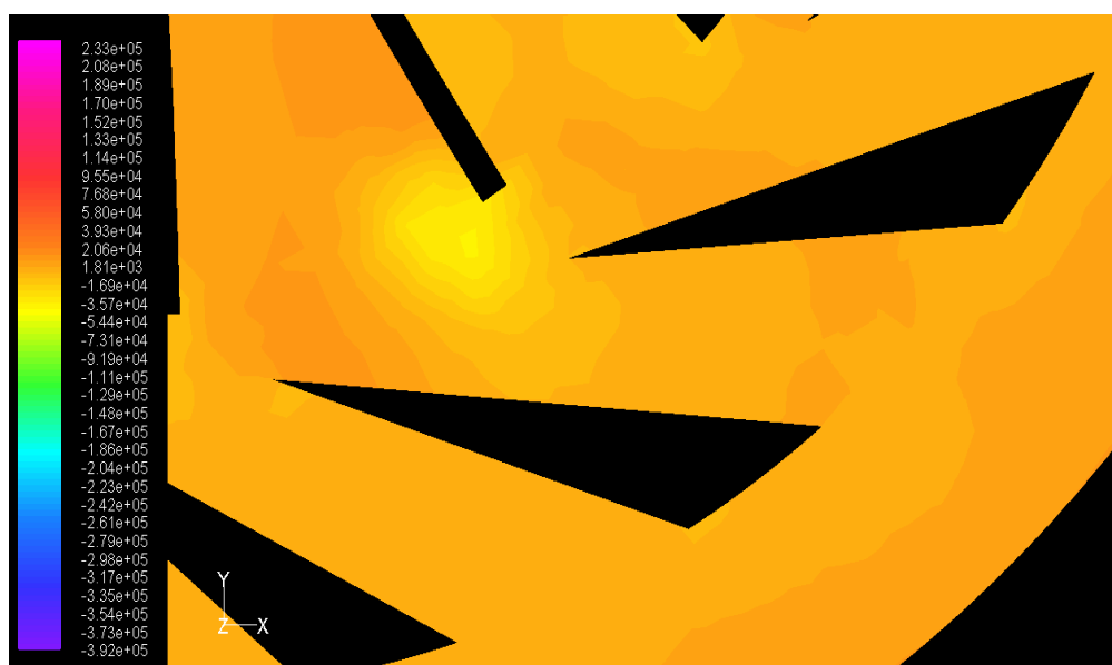
ภาพประกอบ 150 แสดงระดับชั้นความดัน แบบแผ่นเรียบสามเหลี่ยมมุมสูง 24^\circ ตำแหน่งที่ 1
