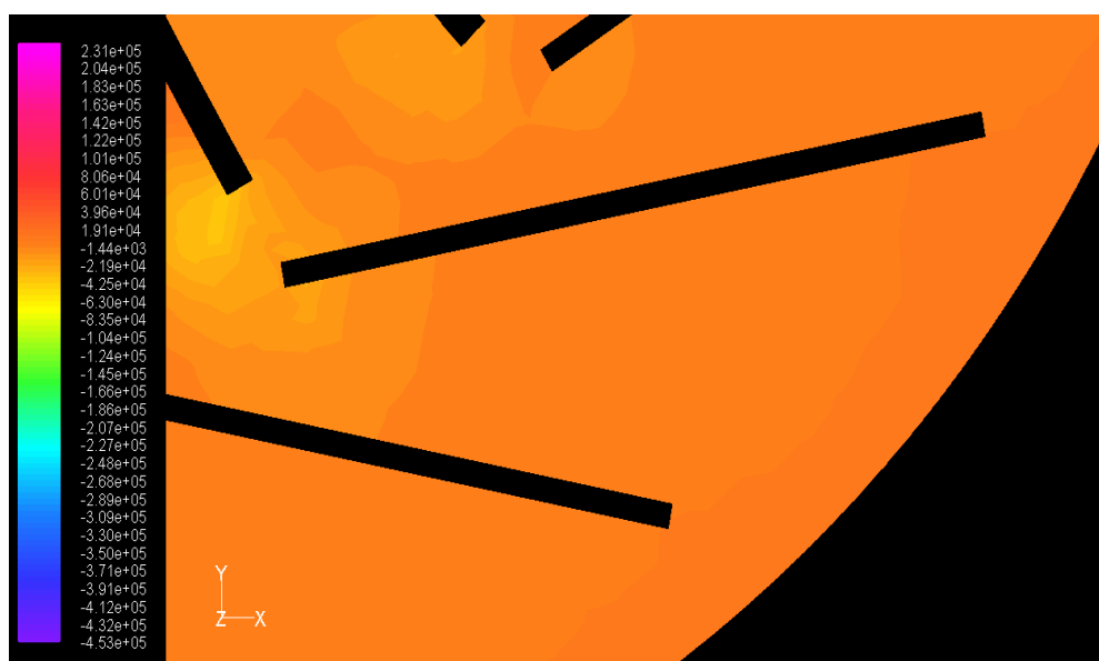
ภาพประกอบ 87 แสดงระดับชั้นความดัน แบบแผ่นครีบตรงมุมลู่ออก 18^\circ ตำแหน่งที่ 1
