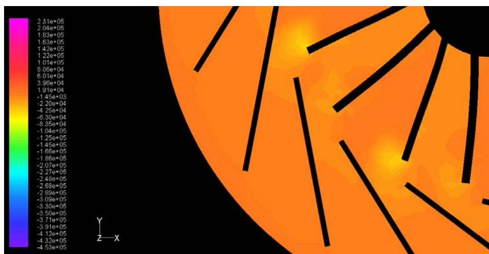
ภาพประกอบ 93 แสดงระดับชั้นความดัน แบบแผ่นครีบกะยายมุม 18^\circ ตำแหน่งที่ 3
