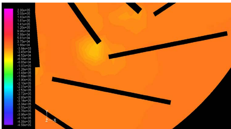
ภาพประกอบ 105 แสดงระดับชั้นความดัน แบบแผ่นครีบตรงมุมลู่ออก 24^\circ ตำแหน่งที่ 1
