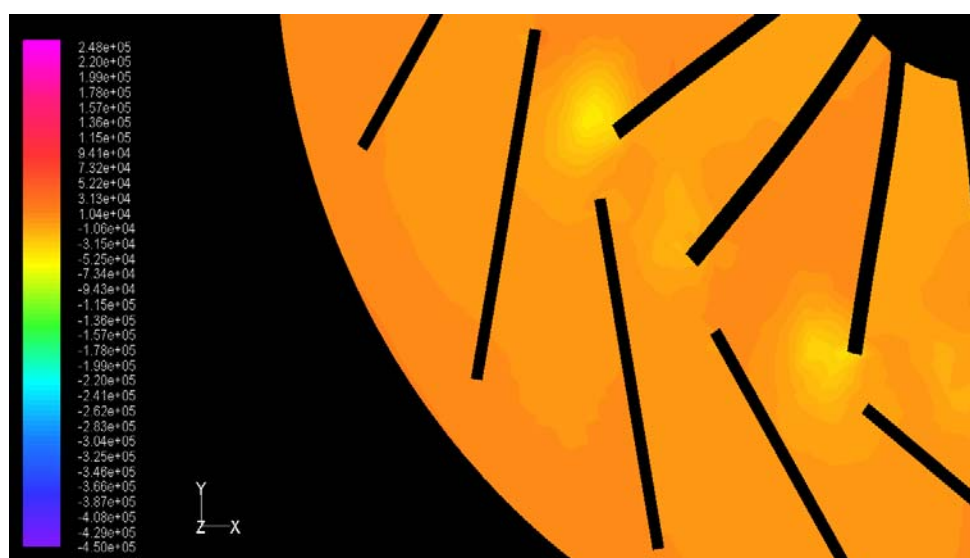
ภาพประกอบ 120 แสดงระดับชั้นความดัน แบบแผ่นคريبตรงมุม 27^\circ ตำแหน่งที่ 3
