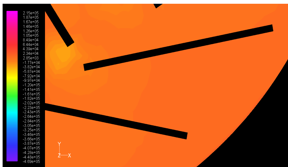
ภาพประกอบ 96 แสดงระดับชั้นความดัน แบบแผ่นครีปตรงมุม 21^\circ ตำแหน่งที่ 1
