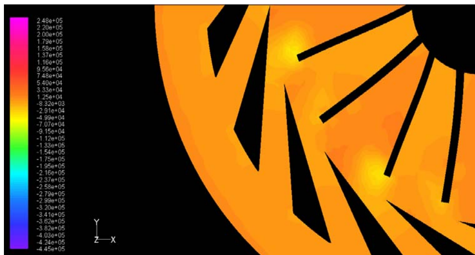
ภาพประกอบ 129 แสดงระดับชั้นความดัน แบบแผ่นเรียบสามเหลี่ยมมุม 15° ตำแหน่งที่ 3
