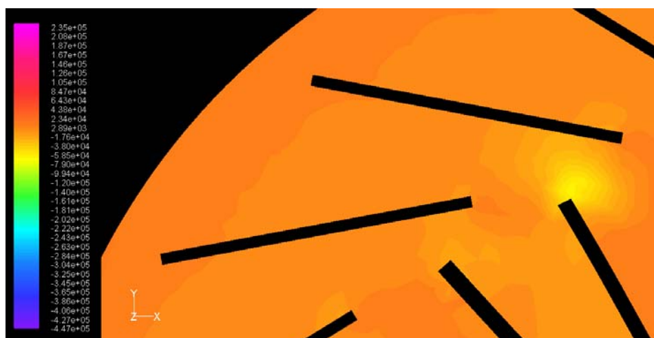
ภาพประกอบ 117 แสดงระดับชั้นความดัน แบบแผ่นคريبตรงมุม 27^\circ ตำแหน่งที่ 2
