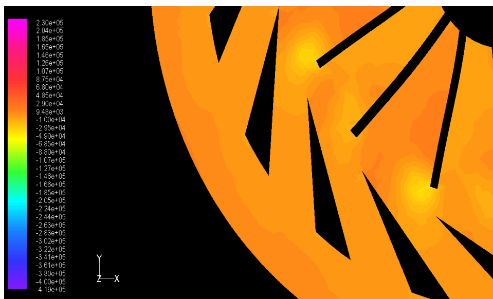
ภาพประกอบ 156 แสดงระดับชั้นความดัน แบบแผ่นเรียบสามเหลี่ยมมุมฉั่ว 24^\circ ตำแหน่งที่ 3
