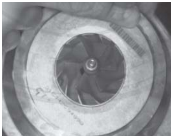
ภาพประกอบ 5 ตัวอย่างใบพัดคอมเพรสเซอร์วีลและดัดฟิวเซอร์แบบไร้ครีบบ
