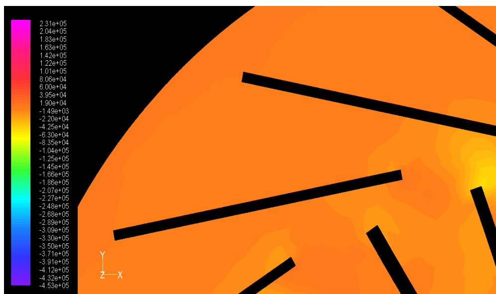
ภาพประกอบ 90 แสดงระดับชั้นความดัน แบบแผ่นครีปตรงมุมลู่ออก 18^\circ ตำแหน่งที่ 2
