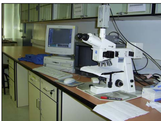
ภาพประกอบ 90 ลักษณะกล้องไมโครสโคปที่ใช้ถ่ายภาพ และการบันทึกภาพ
