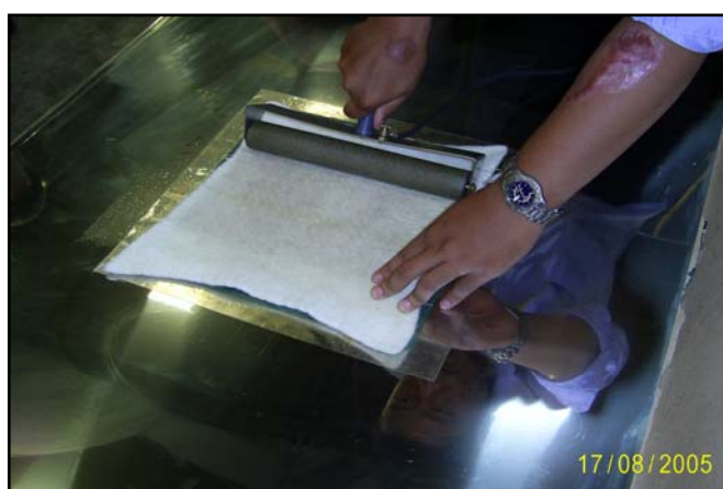
ภาพประกอบ 34 การสร้างกริดวงกลมบนแผ่นเหล็กกล้าไร้สนิมก่อนขึ้นรูปอ่างล้างภาชนะ
