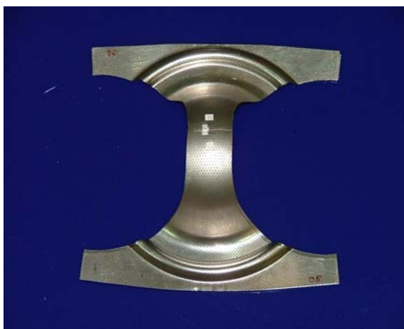
ภาพประกอบ 87 การขึ้นรูปชิ้นทดสอบจากแผ่นเต็มถูกตัดขอบรัศมี 80 mm.
