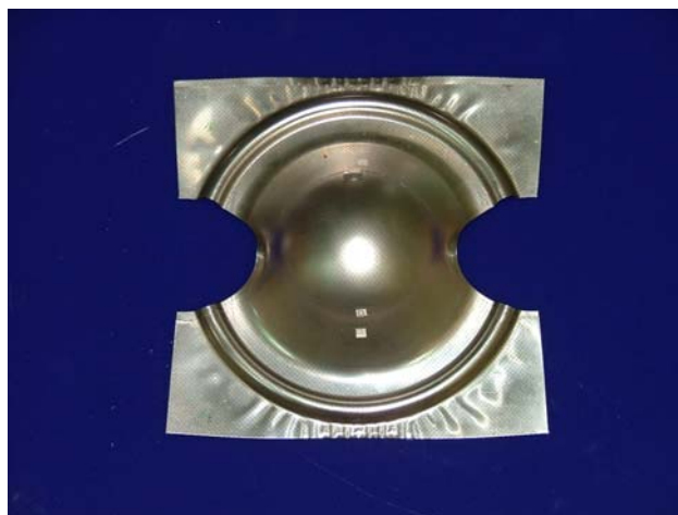
ภาพประกอบ 82 การขึ้นรูปชิ้นทดสอบจากแผ่นเต็มถูกตัดขอบรัศมี 40 mm.
