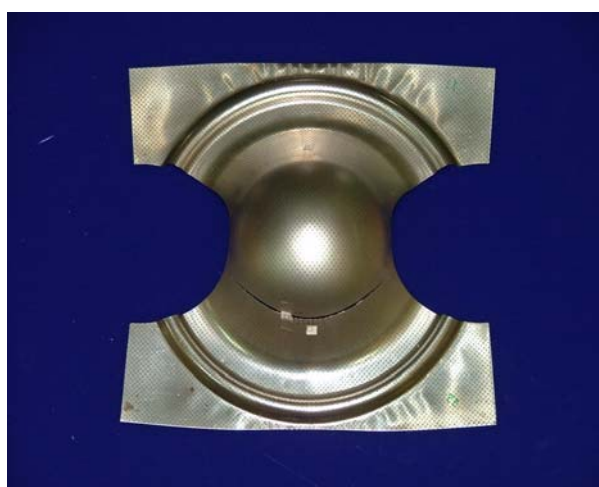
ภาพประกอบ 83 การขึ้นรูปชิ้นทดสอบจากแผ่นเต็มถูกตัดขอบรัศมี 50 mm.
