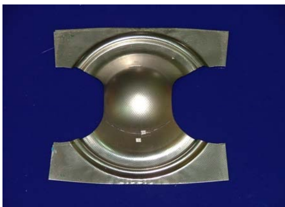
ภาพประกอบ 85 การขึ้นรูปชิ้นทดสอบจากแผ่นเต็มถูกตัดขอบรัศมี 65 mm.
