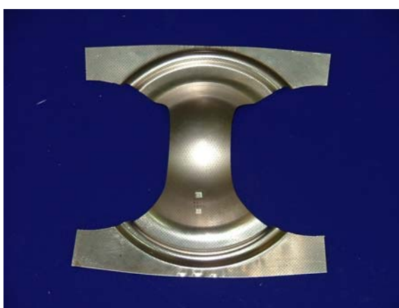
ภาพประกอบ 86 การขึ้นรูปชิ้นทดสอบจากแผ่นเต็มถูกตัดขอบรัศมี 72.5 mm.
