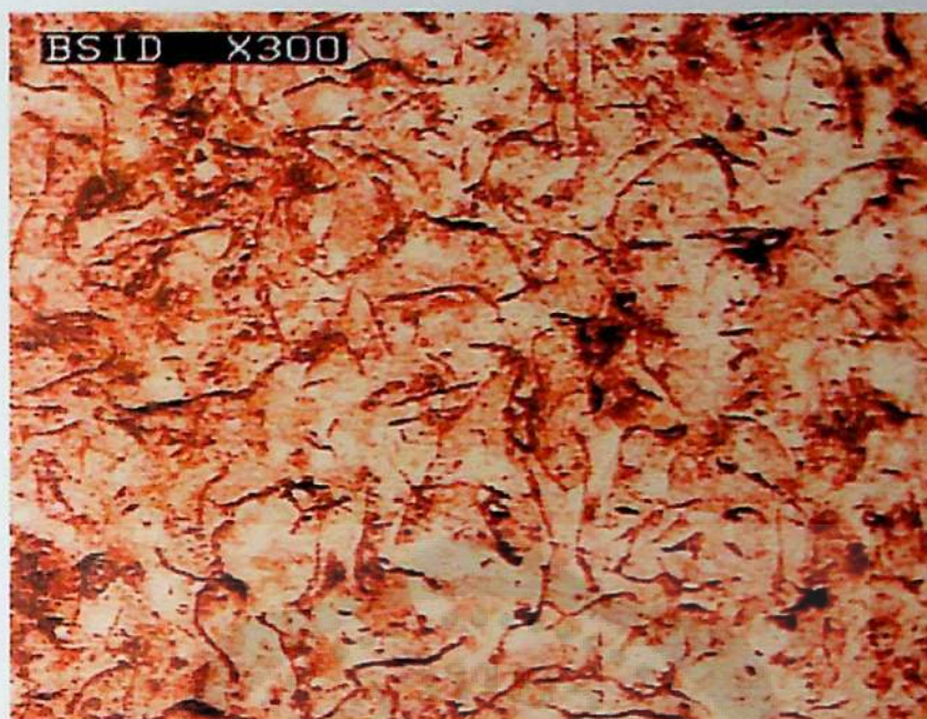
รูปที่ 4.7 แสดงโครงสร้างชิ้นงานหล่อครั้งที่ 2 ของการหล่อชิ้นงานที่ 1
