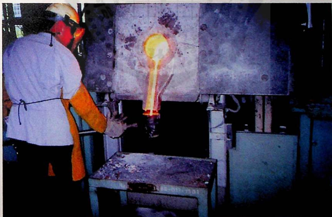
รูปภาคผนวกที่ 4 แสดงการเทน้ำเหล็กออกจากเตา
